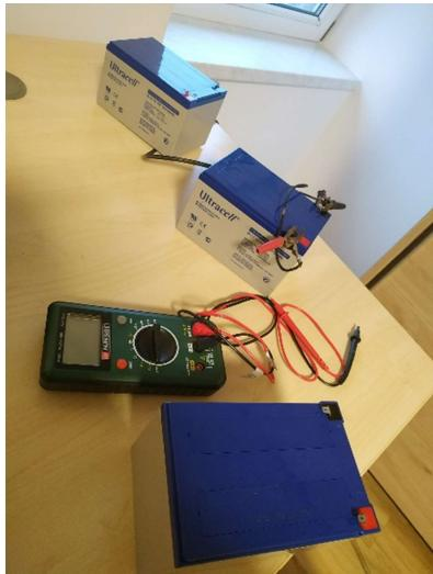
Zvezal sem jih zaporedno, da sem dobil napetost 36 V in kapaciteto 12 Ah.
