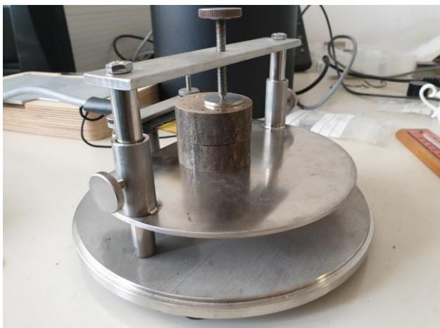
*Slika 10 - Meritev toplotnih lastnosti Cu-Al-Mn ( $\text{Ø}40 \times 12 \text{ mm}$ ) pri sobni temperaturi.*
