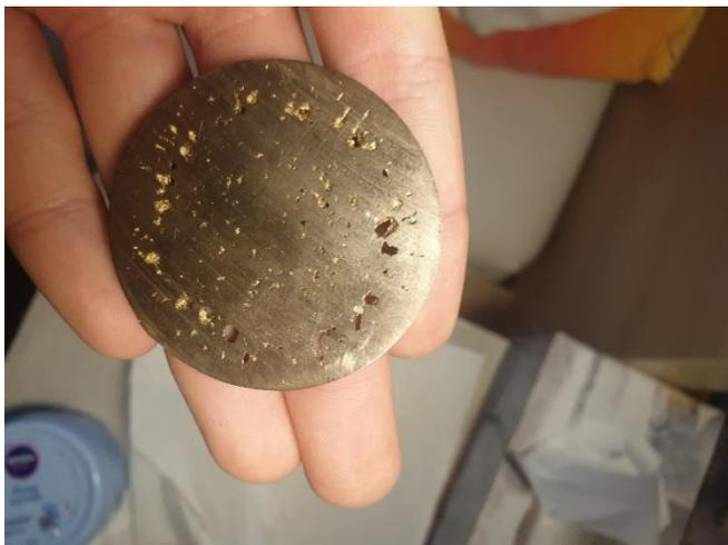
*Slika 4 - Vzorec iz zlitine Cu-Al-Ni ( $\text{\O}40 \times 12 \text{ mm}$ ) izdelan in pripravljen za analizo toplotnih lastnosti.*
