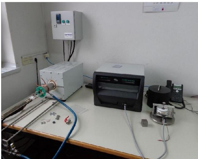
Slika 3 - Naprava za meritve toplotnih lastnosti Hot Disk TPS 2200.
