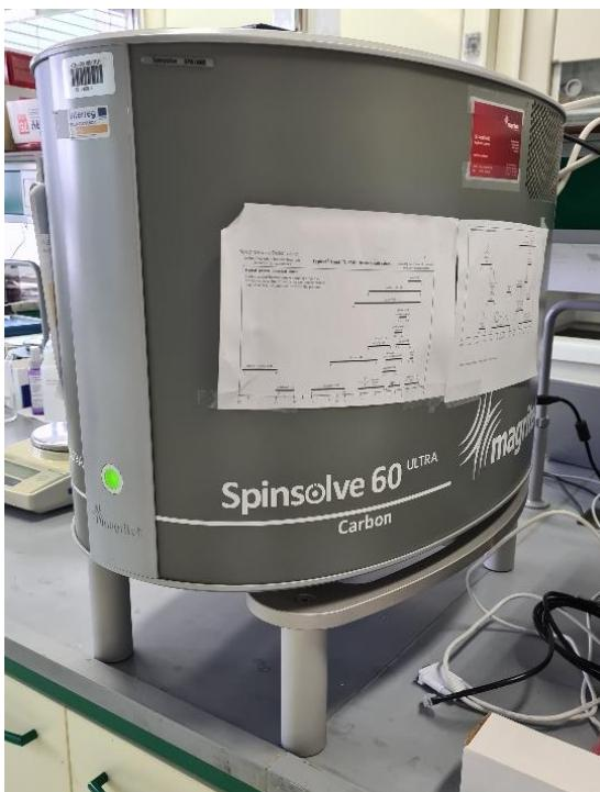
Slika 7: uporabljen NMR spektrometer, Ana Šmid, 16.2.2022
