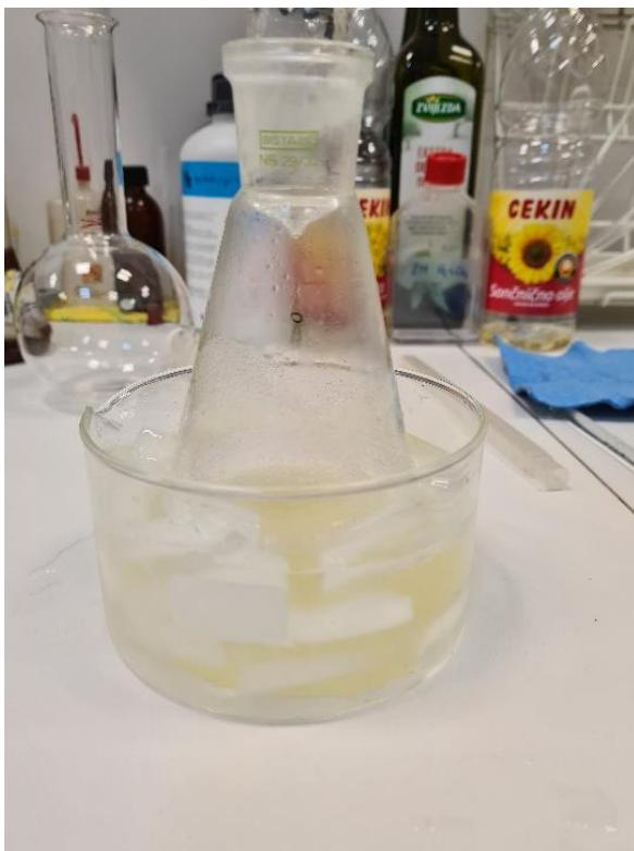
Slika 2: fotografija zmesi med hlajenjem v ledeni kopeli po 90 minutah pod refluksom, Ana Šmid, 3.2.2022
