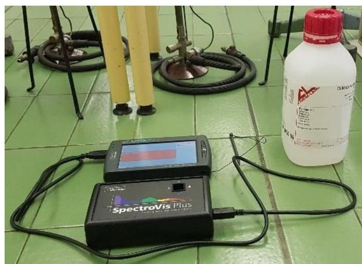
Slika 23: Uporabili smo spektrofotometer SpectroVis Plus (Vernier).
