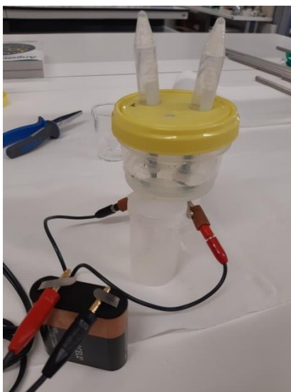
Slika 5: Alternativni sistem za oceno aktivnosti katalizatorjev za cepitev vode
