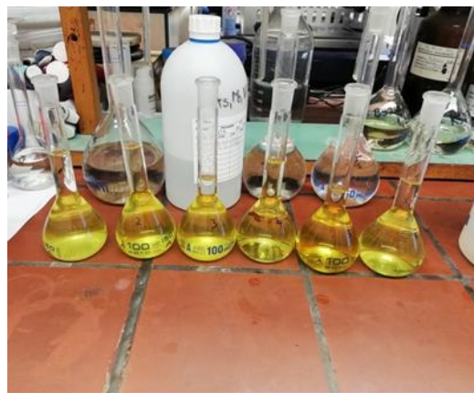
Slika 8: Kuhanje standardnih raztopin (levo) in standardne raztopine po kuhanju (desno).
