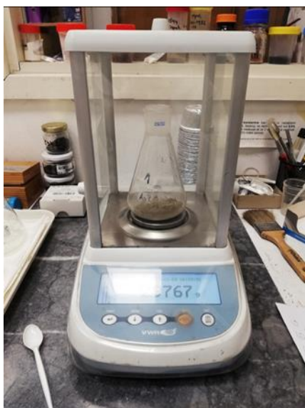
Slika 7: Tehtanje vzorcev za razklop v zlatotopki (levo) in raztopine po razklopu (desno).
