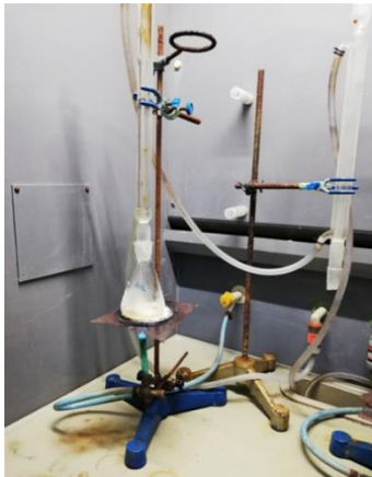
Slika 8: Kuhanje standardnih raztopin (levo) in standardne raztopine po kuhanju (desno).
