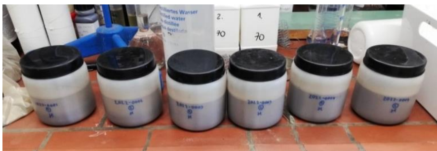
Slika 14: Suspenzije za merjenje električne prevodnosti.
