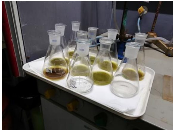
Slika 8: Kuhanje standardnih raztopin (levo) in standardne raztopine po kuhanju (desno).
