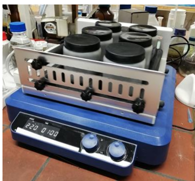
Slika 13: Stresalnik - priprava vzorcev za merjenje pH.
