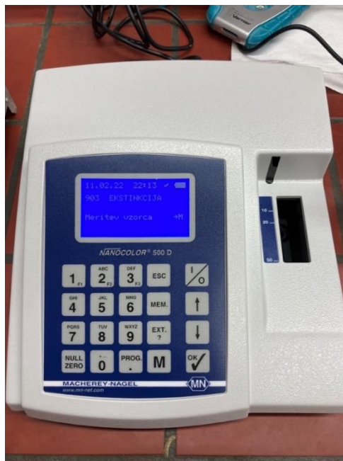
Slika 13: Spektrofotometer z nastavljeno valovno dolžino merjenja absorbance pri 436 nm.
