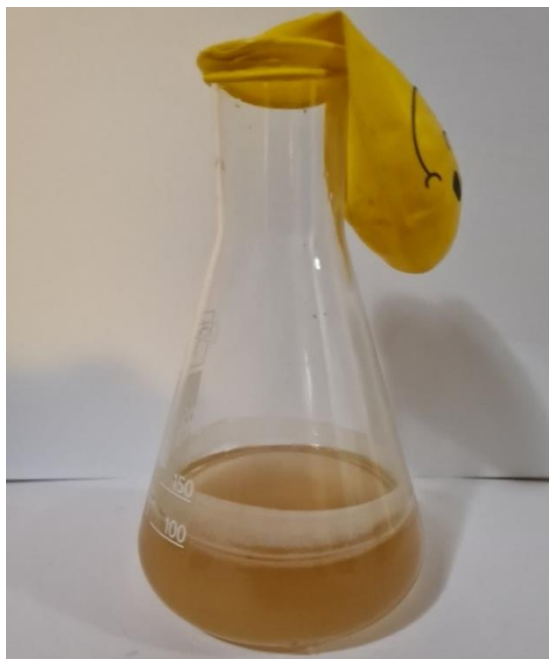
Slika 9: Priprava za merjenje količine nastalega CO 2
