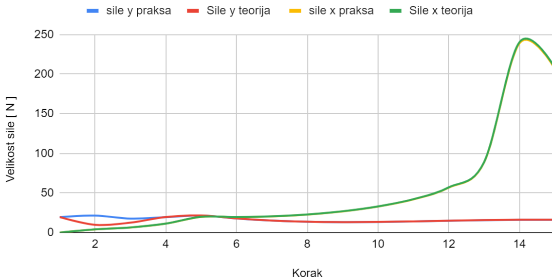
Graf 3: Teoretične in praktične sile v navpični in vodoravni smeri na model med navpičnim gibanjem
