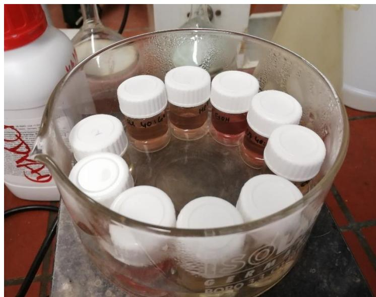
Slika 16: Vzorci z železovim sulfatom v vodni kopeli (lastni vir)
