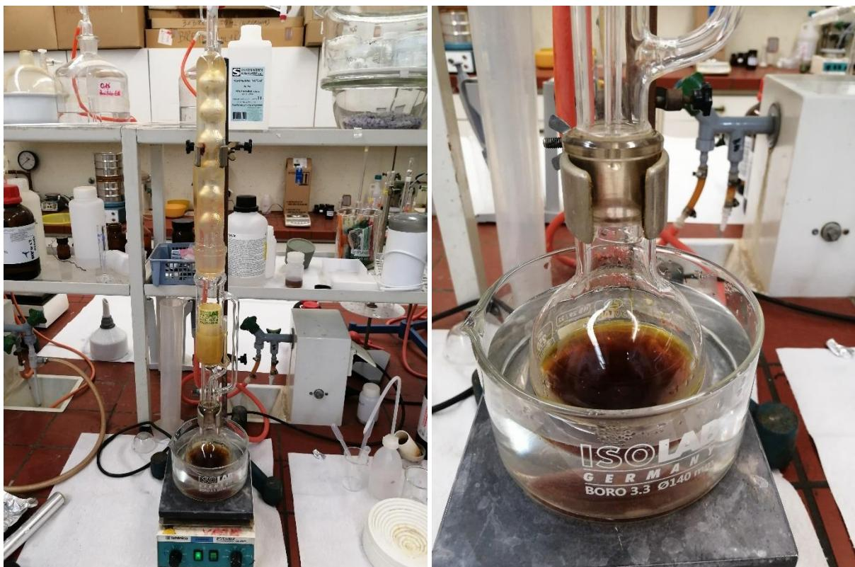
Slika 6: Celotna Soxhlet priprava (lastni vir)
