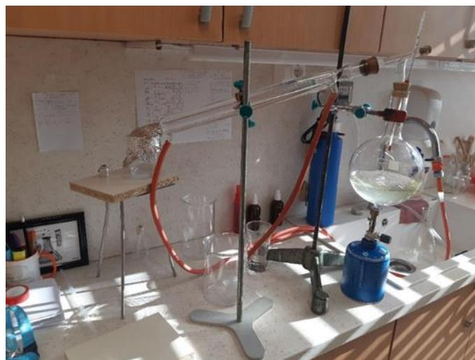
Slika 12: Laboratorijska destilacijska aparatura.
