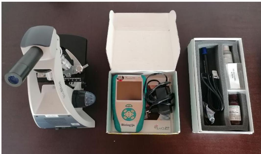
Slika 8: Mikroskop, LabQuest in merilec koncentracije raztopljenega kisika (lasten vir)
