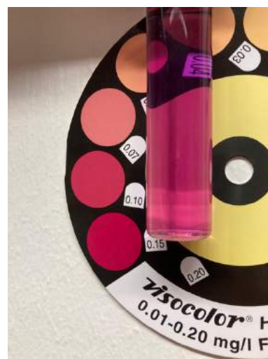
Slika 7: Dokazovanje železovih ionov II [27]
