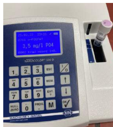
Slika 5: Dokazovanja fosfatnih ionov [25]
