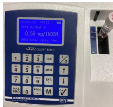
Slika 3: Dokazovanje nitratnih ionov [23]
