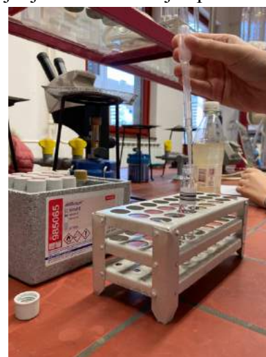
Slika 2: Dokazovanje amonijevih ionov [22]
