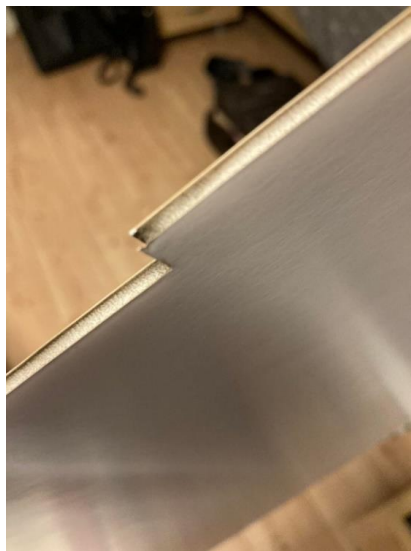
Slika 29: Viden utor, narejen ob izrezu z laserjem
