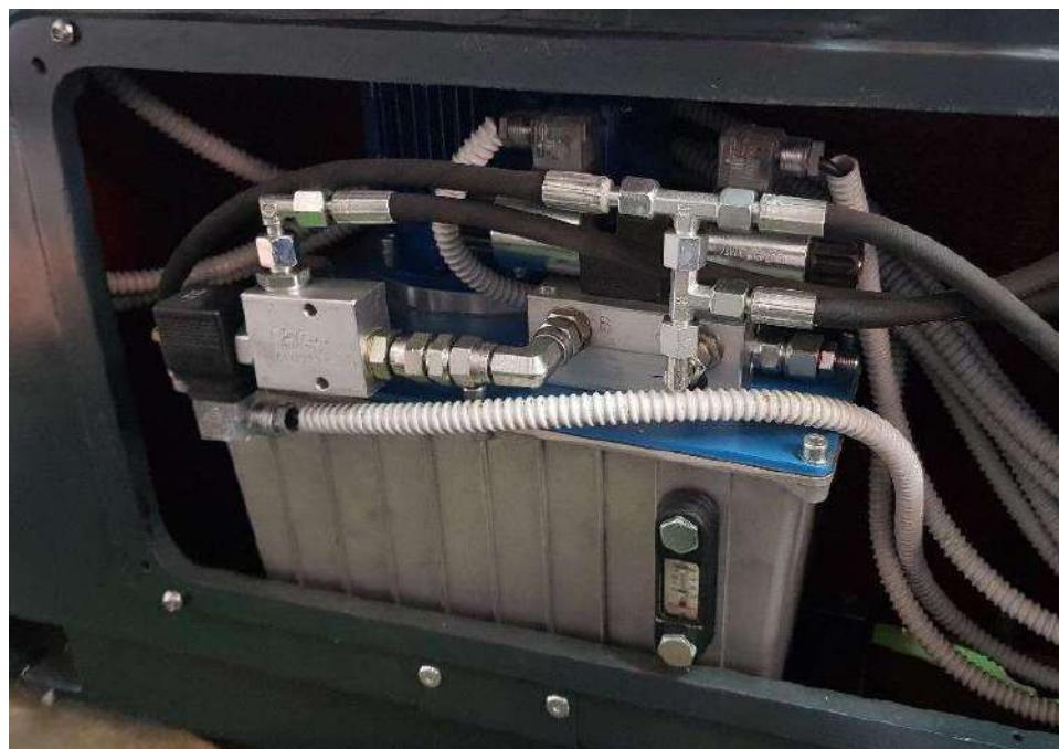
*Slika 16: Hidravlični ventili
