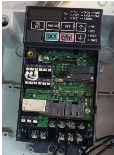
*Slika 14: Frekvenčni pretvornik
