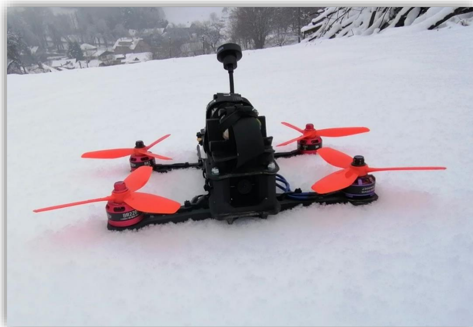
Slika 48: Doma izdelan FPV dron
