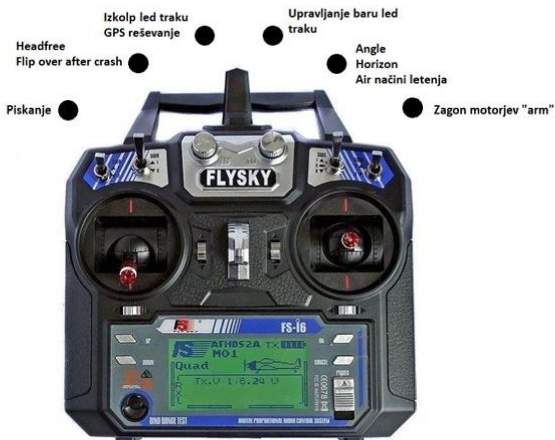
Slika 44: Prikaz funkcij stikal in potenciometrov
