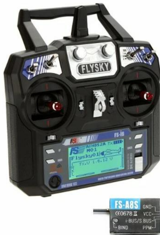
Slika 5: Daljinski upravljalnik FS-i6 in sprejemnik FS-A8S
