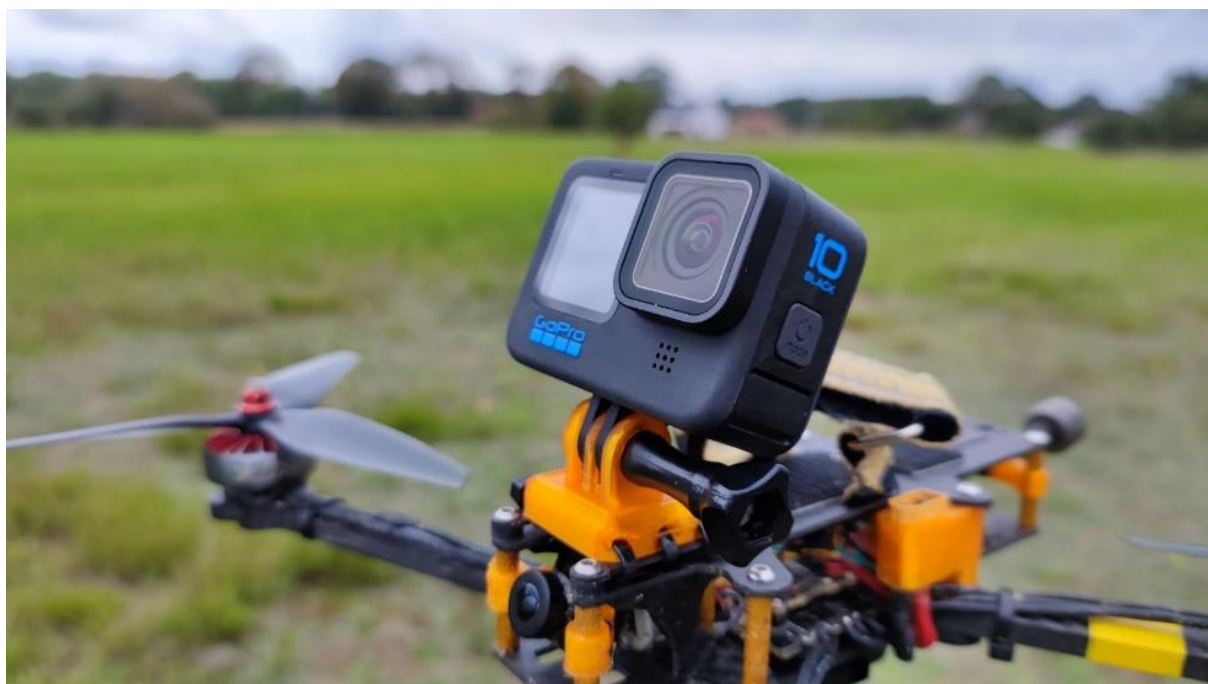
Slika 12: Akcijska kamera na FPV dronu
