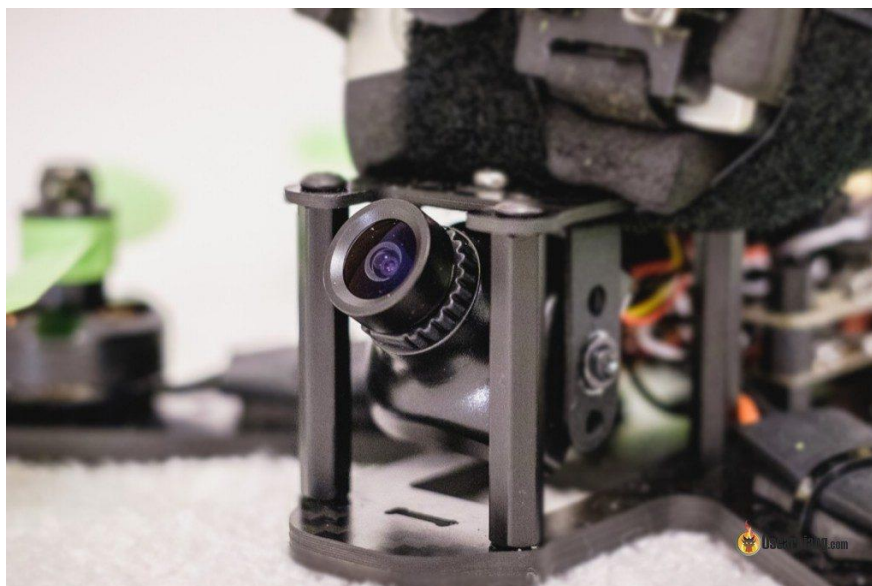
Slika 21: FPV kamera na dronu
