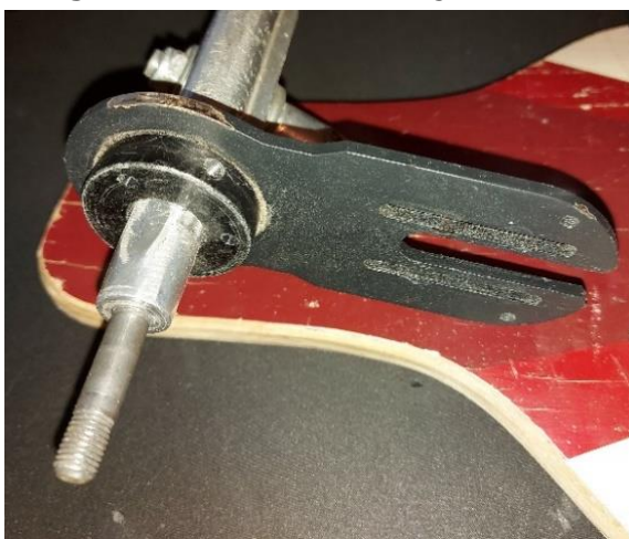
Slika 24 Nosilec pritrjen na podvozje rolke Vir: (osebni vir)
