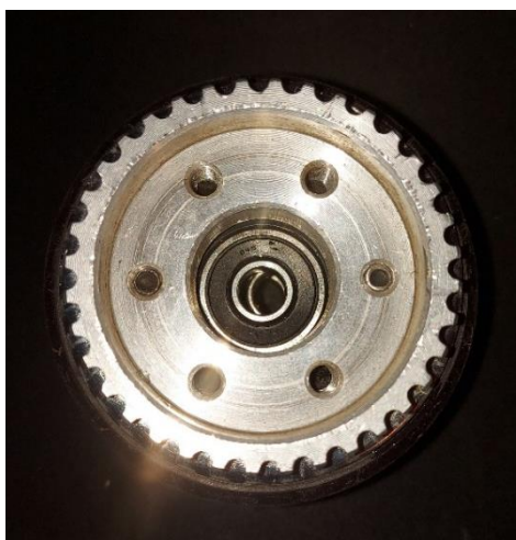
Slika 26 Zobnik pritrjen na kolo rolke Vir: (osebni vir)
