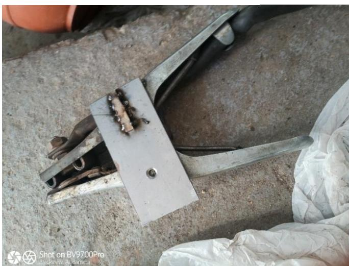
Slika 29: profil za namestitev motorčka (lasten vir)
