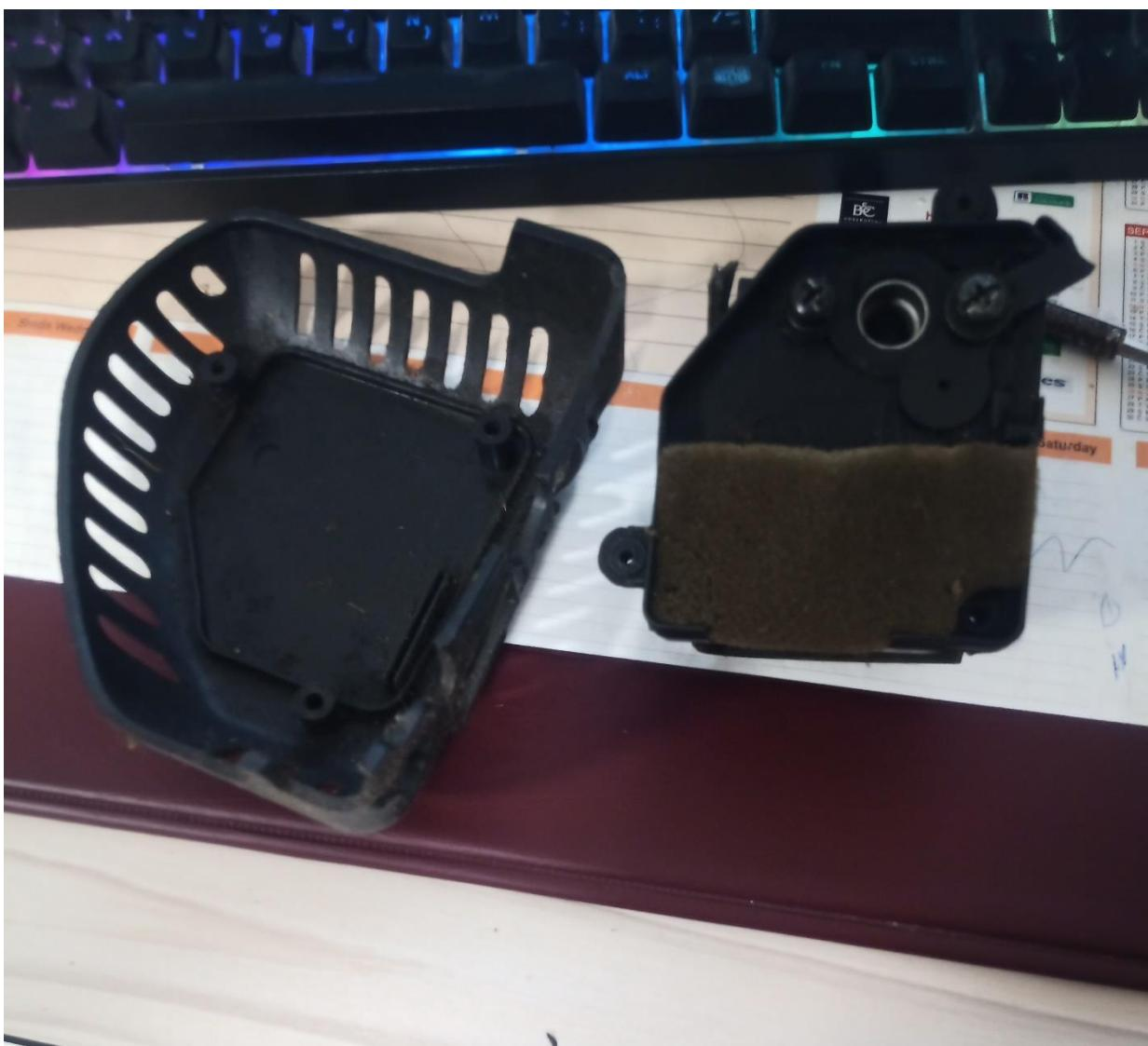
Slika 17: Uplinjač nitne kosilnice AL-KO FRS 251 (lasten vir)
