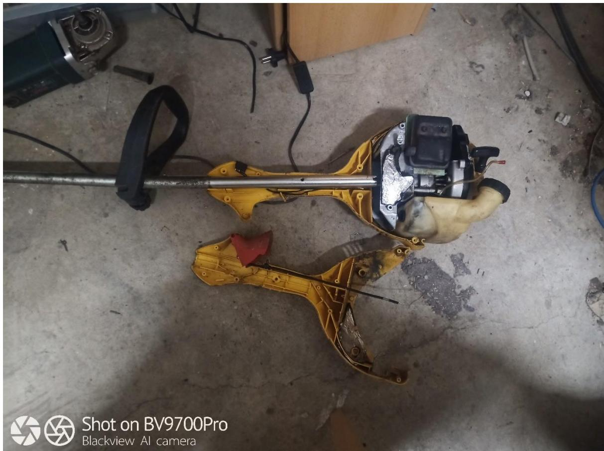
Slika 18: Postopek dol jemanja bencinskega motorja iz nitne kosilnice (lasten vir)
