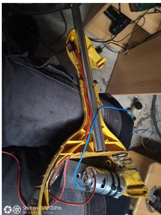
**Slika 31: Namestitev stikala in kablov v ohišje (lasten vir)**
