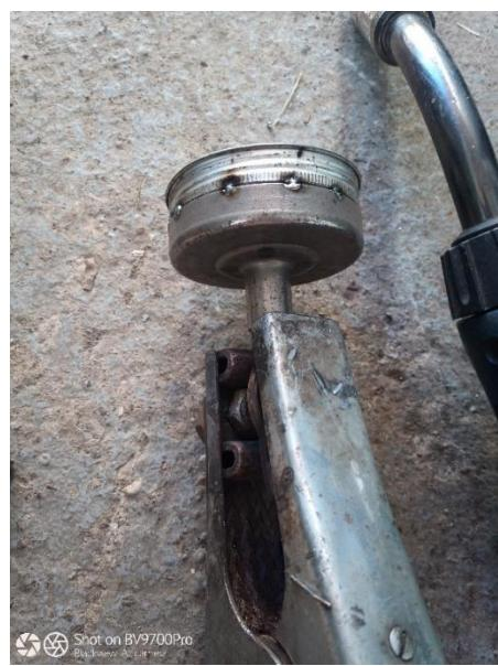
Slika 27: Krog navarjen na prenos energije (lasten vir)
