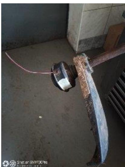
Slika 37: Prilepljen lepilni trak na glavo kose (lasten vir)
