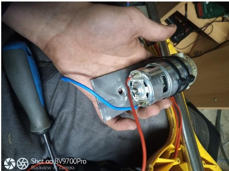
**Slika 30: Pritrditev motorčka na pritrditveni profil in lotani kabli na motorčku (lasten vir)**
