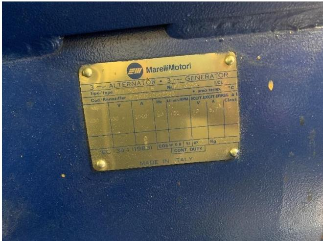
Slika 3: Nazivni podatki sinhronskega generatorja (vir: lasten vir)
