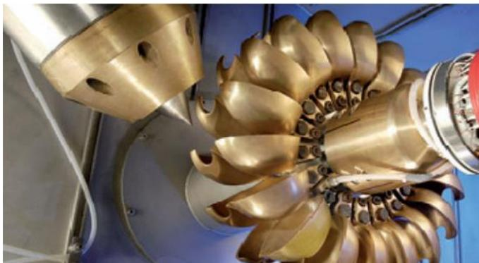
Slika 4: Peltonova turbina (vir: Vodne turbine: fakulteta za strojništvo)
