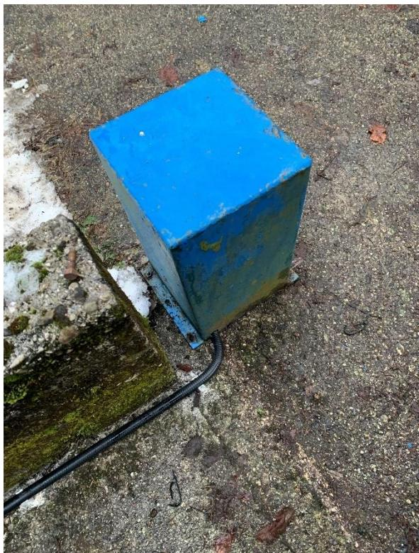
Slika 26: Nameščen hidrostatični merilnik tekočin (vir: lasten vir)
