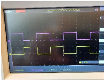
Slika 16: Impulzi na izhodu Arduina
