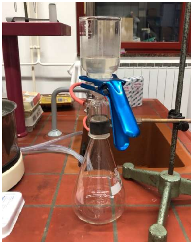
Slika 8: Filtriranje z napravo za vakuumsko filtracijo ISOLAB
