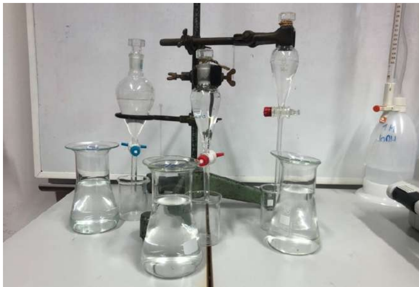
Slika 6: Ločevanje oborine z lijem ločnikom
