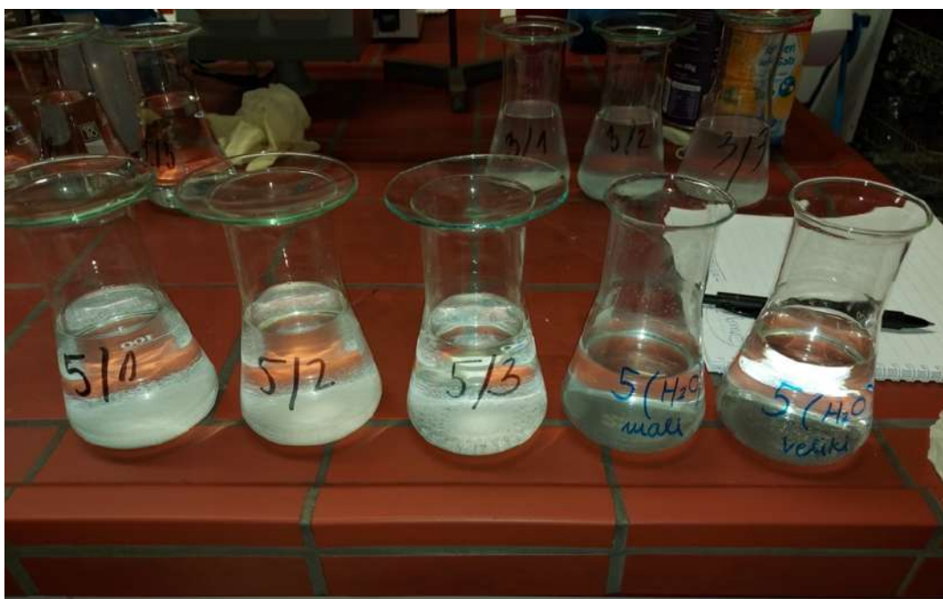
Slika 7: Nastanek oborine pri raztapljanju v 15 % KOH (levo) v primerjavi z raztapljanjem v vodi (desno)
