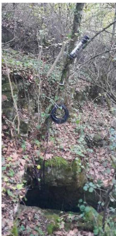
Slika 27: Sonde za zvezne meritve gladine vode, temperature vode in električne prevodnosti vode.
