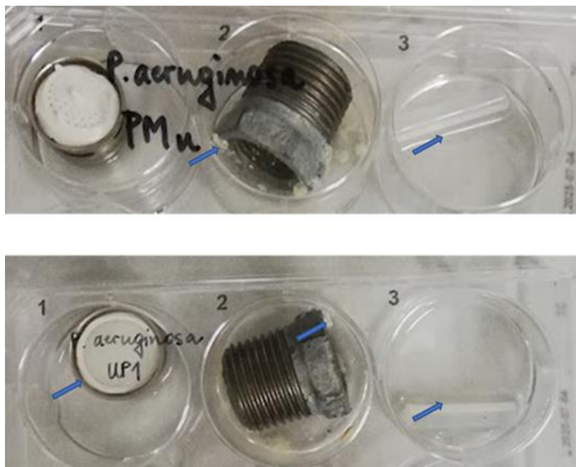
Slika 8: Nastanek biofilmov na plastičnem filtru (1), kovinskem ventilnem vijaku (2) in urinskem katetru (3) po tretiranju z bakterijsko kulturo P. aeruginosa . Biofilmi so vidni kot rumenkaste obloge (označeni z modro puščico) (lasten vir)
