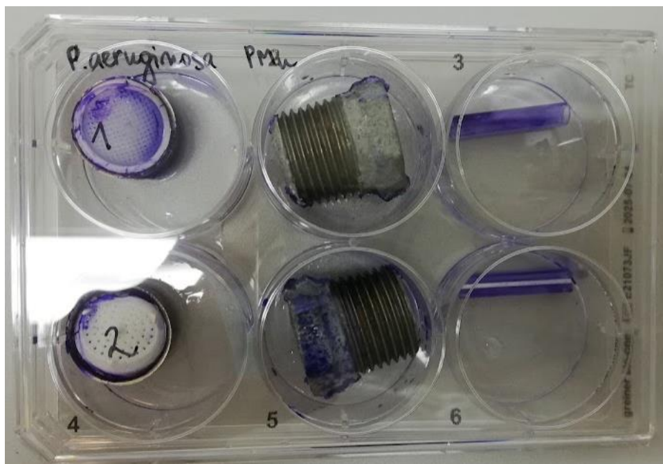
Slika 9: Primer preparatov po barvanju s kristal vijoličnim barvilom in 6-kratnim spiranjem preparatov s fiziološko raztopino. Več kot je modre barve, večja je količina biofilma na materialu. (lasten vir)
