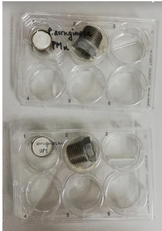
Slika 7: 2 plošči s 6 vdolbinami, v katerih so predmeti po umetnem okuženju z bakterijsko kulturo in 24 urni inkubaciji (lasten vir)
