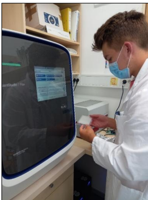
Slika 8: Delo na napravi QuantStudio 7 Flex Real-Time PCR System. Prikazano je vstavljanje reagen nega nosilca v aparat (avtorica fotografije I. Sotlar).
