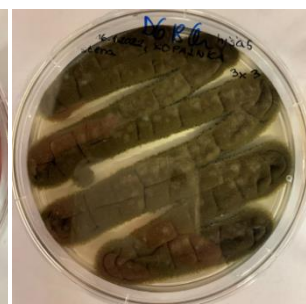
Slika 143: Hiša 5, odvzet vzorec s stene kopalnice, DG18
