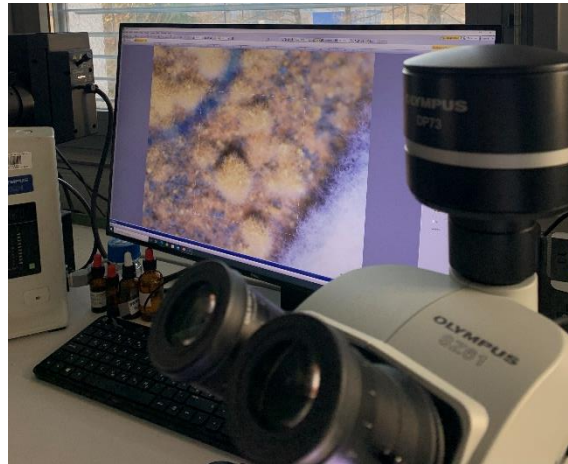
Slika 146: Kamera za fotografiranje na stereo mikroskopu in slika na zaslonu računalnika Vir: Biotehniška fakulteta, 2022
