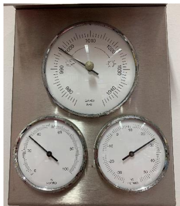
Slika 18: Prikaz aparatur za merjenja tlaka (barometer), vlage (higrometer) in temperature (termometer) v šolskem laboratoriju Vir: Baler, K. (2022)
