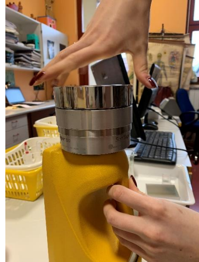
Slika 15: Nadevanje sterilne plošče na napravo za filtracijo zraka Vir: Baler, K. (2022)
