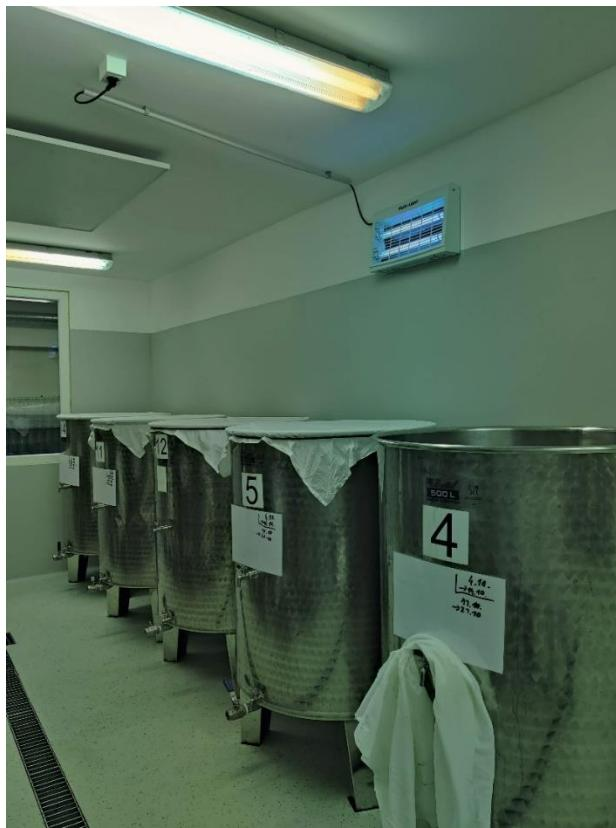
Slika 3: Kombučarna BeLife, Kamnik. Fermentacijska soba, kjer se nahaja 10 sodov s kombučo. Na sliki so 4 sodi, kot poteka fermentacija ter sod št. 4, ki je pripravljen na vzorčenje (odstranjenja prevleka, ki ščiti pred kontaminacijo insektov).
