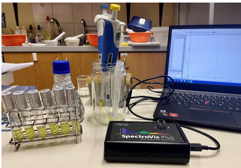
Slika 11: Delovna površina, pripravljena na merjenje spremembe absorpcije s spektrofotometrom za določanje encimske aktivnosti gvajakol peroksidaze (lastni vir)
