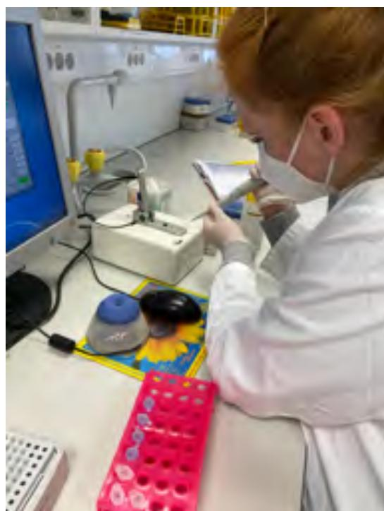
Slika 33: Določanje koncentracije izolirane DNA na napravi NanoDrop
