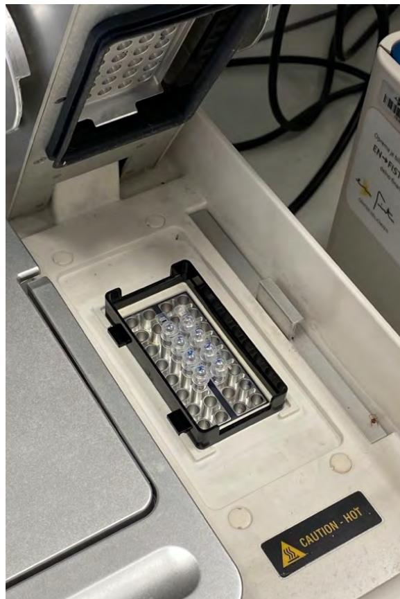
Slika 31: Naprava za izvedbo reakcije PCR z vstavljenimi mešanicami
