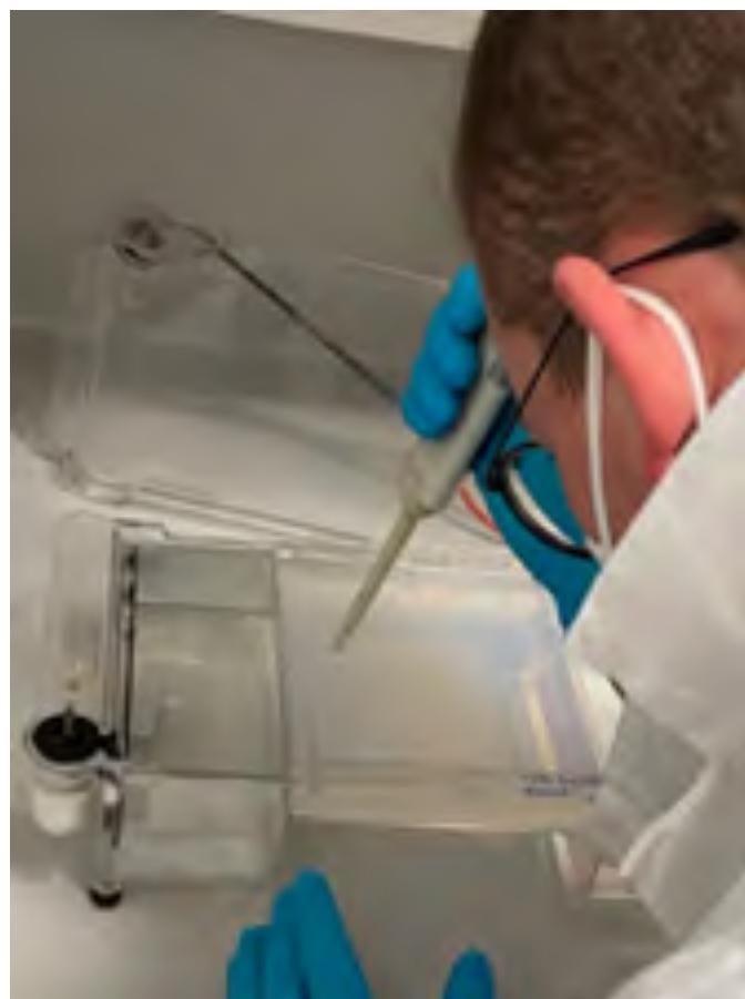
Slika 32: Prikaz nanašanja reakcijskih mešanic na agarozni gel, kjer je potekla elektroforeza
