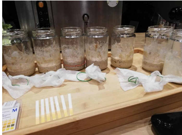
Slika 14: Merjenje pH pri vzorcih droži
