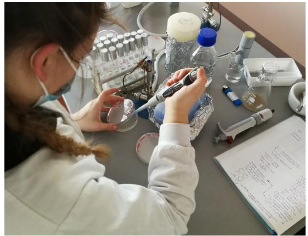
Slika 18: Sterilno redčenje suspenzije mokarjev in prenašanje suspenzije na gojišča
