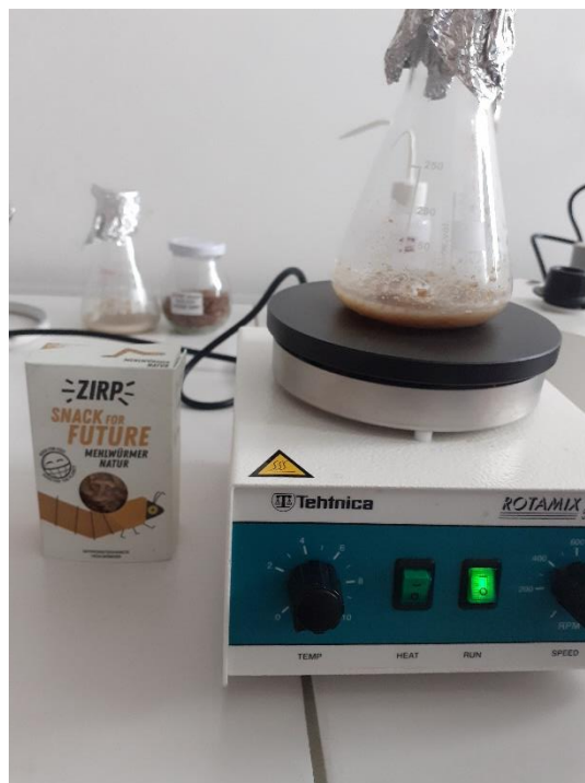
Slika 16: Resuspendirani vzorec domačih mokrjev in mešanje vzorca z magnetnim mešalom
