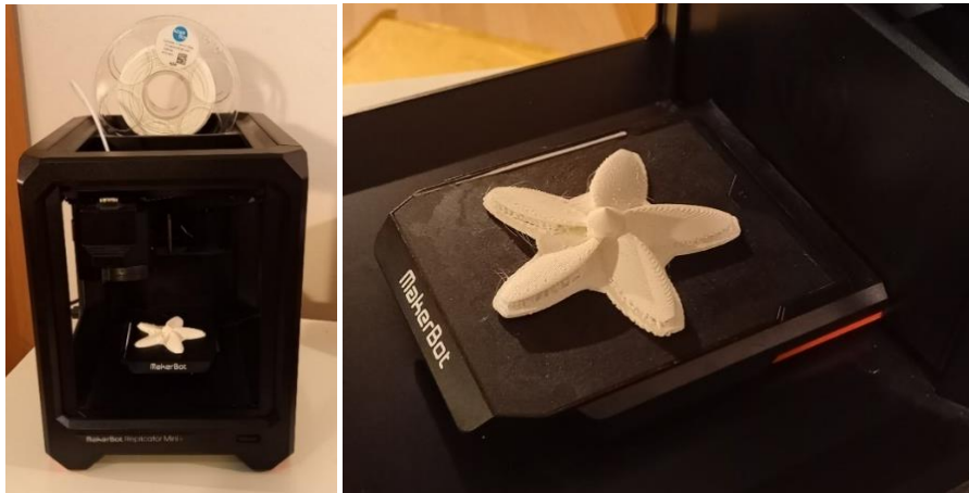
Slika 6: Propeler s petimi lopaticami, izdelan s 3D tiskalnikom MakerBot Replicator Mini+.
