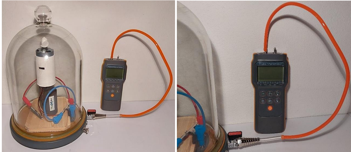
Slika 12: Merjenje zračnega tlaka z digitalnim manometrom. Slika na desni strani prikazuje, kako je bila cev priključena na ventil vakumske komore.
