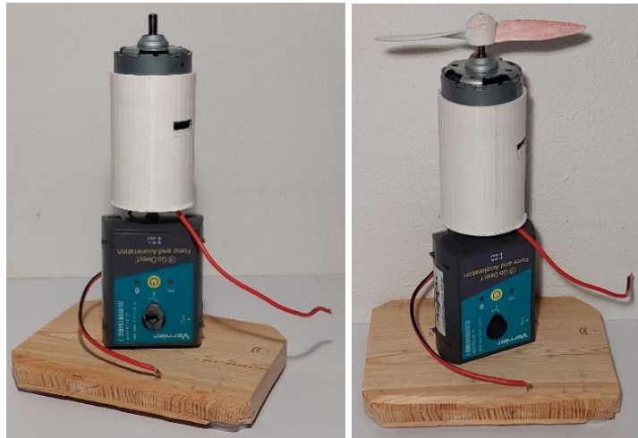
Slika 13: Električni motor v 3D natisnjem okvirju, pritrjen na Bluetooth merilnik sile (leva slika). Propeler z dvema lopaticama, pritrjen na električni motor (desna slika).
