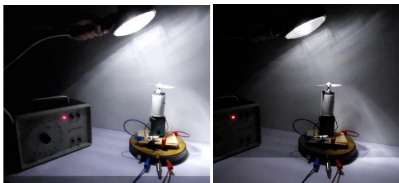
Slika 9: Prikaz merjenja frekvence vrtenja s strobooskopom. Leva in desna slika prikazujeta utripanje reflektorske svetilke.
