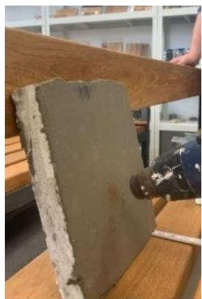
Slika 69: Superflex 2K po preizkušanju toplotne odpornosti
