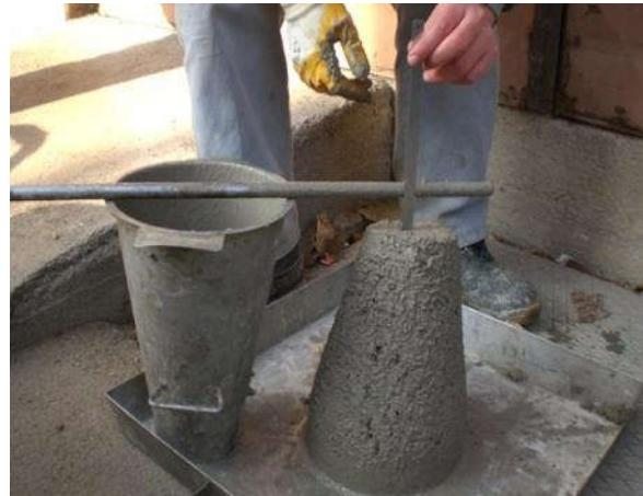
Slika 8: Preverjanje konsistence betona
