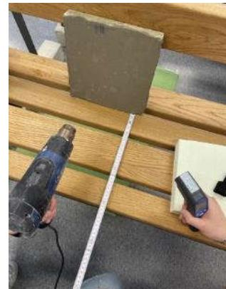
Slika 68: Superflex 2K med preizkušanjem toplotne odpornosti
