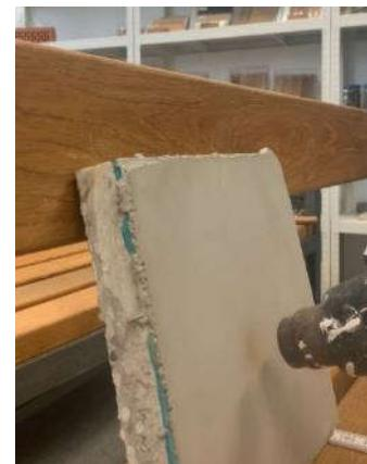
Slika 70: Classic med preizkušanjem toplotne odpornosti
