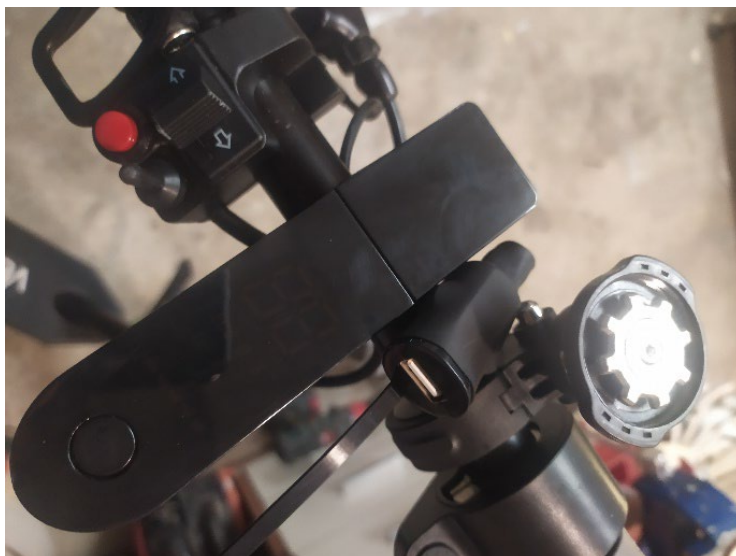
Slika 23: Ponovna pritrditev zaščitnih plastik 2/2 (lasten vir)
