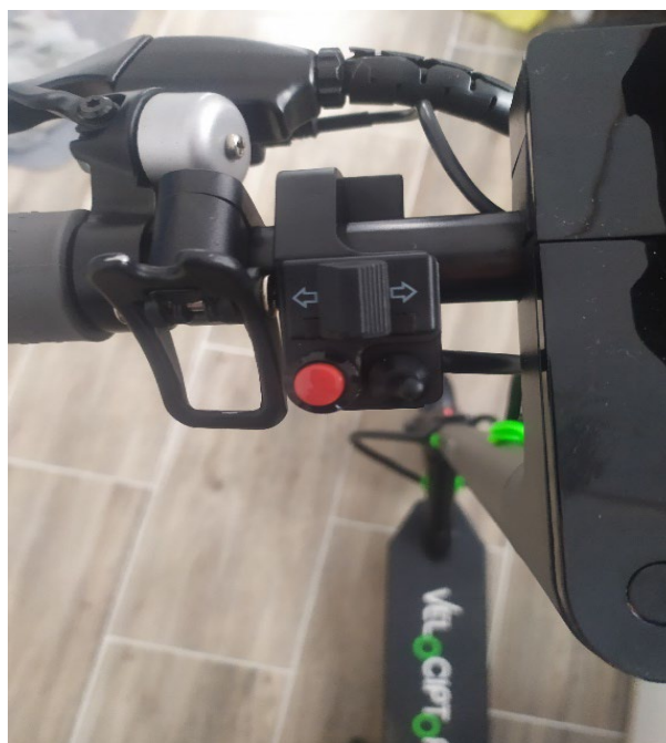
Slika 6: Zaklep za krmilo (lasten vir)
