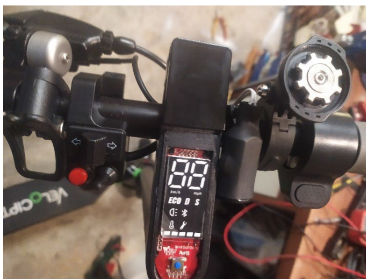
Slika 22: Ponovna pritrditev zaščitnih plastik 1/2 (lasten vir)
