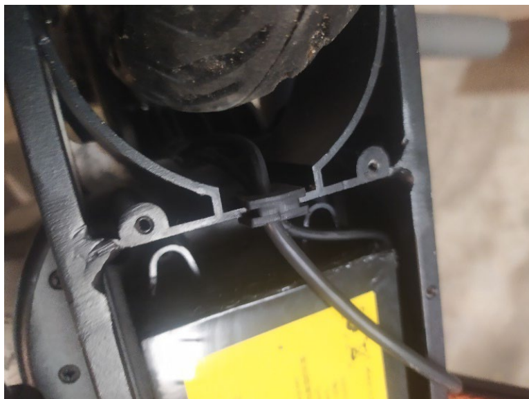
Slika 15: Napeljava kabla na smernike (lasten vir)
