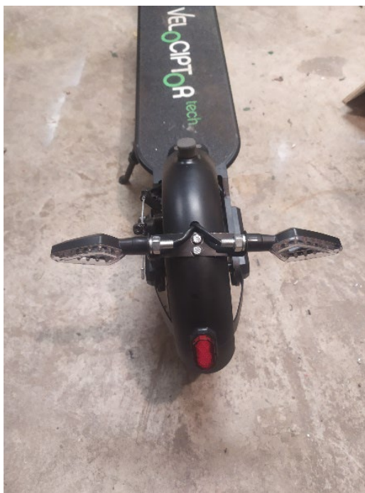
Slika 14: Pritrjeni smerniki (lasten vir)
