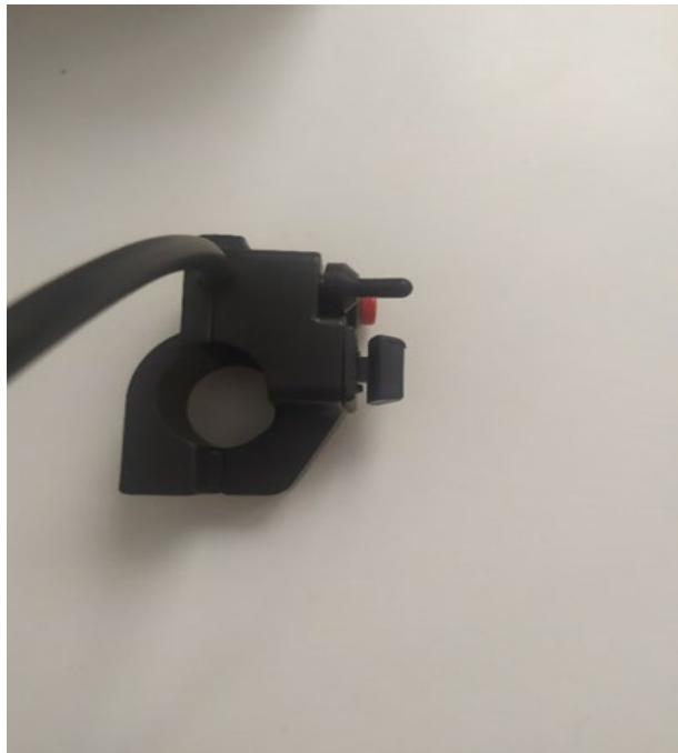
Slika 5: Multifunkcijsko stikalo slikano s strani (lasten vir)
