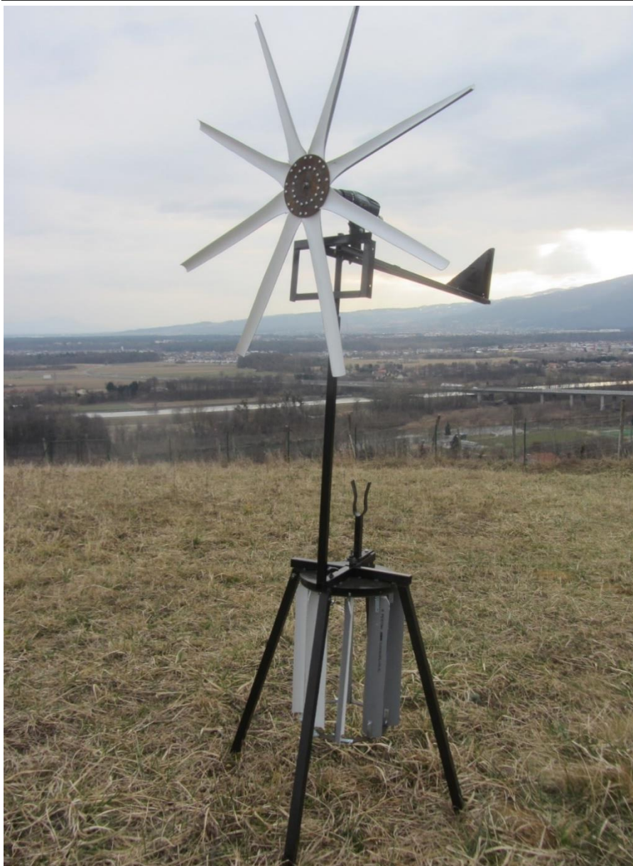
Slika 13: Prvo testiranje integrirane vetrnice z elektromotorjem
