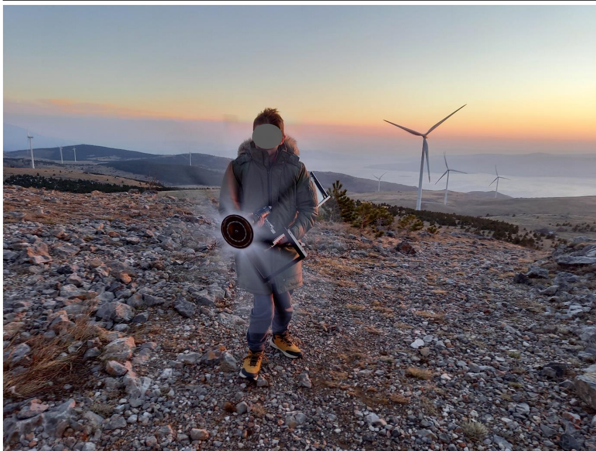
Slika 14: Zadnje testiranje integrirane vetrnice z elektromotorjem baterijskega vrtalnika
