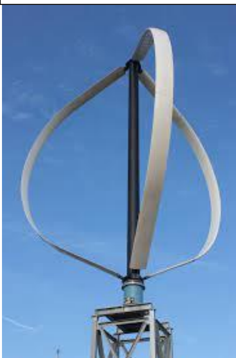
Slika 3: Vertikalna vetrna turbina s tremi lopaticami
