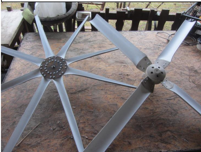
Slika 11: Običajna (desno) in predelana vetrnica (levo) z osmimi rezili
