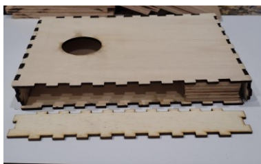
SLIKA 3. 28: POGLED ZGRADBE OGRODJA KALIMBE OD STRANI.
