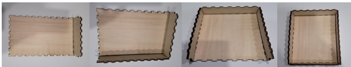
SLIKA 3. 15, 3. 16, 3. 17 IN 3. 18: SPODNJA VEZNA PLOŠČA IN STRANICE
