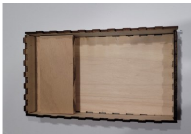
SLIKA 3. 27: DODAJANJE VEZNIH PLOŠČ DIMENZIJI 140 MM X 50 MM X 10 MM.
