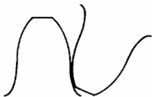
Slika 13 : Oblika bokov zob ( https://dijaski.net/gradivo/mht_sno_zobniska_gonila_01 )
