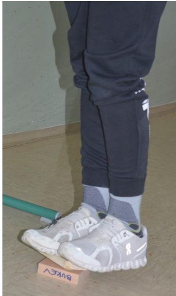
Slika 6: Delovanje stalne sile na vzorec lesa (Avtorica: Patricija Majerič, Laporje, 2022)
