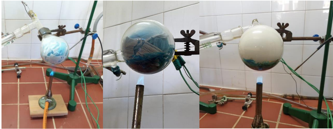
Slika 10. Taljenje in uplinjanje v različnih časovnih obdobjih reakcije
