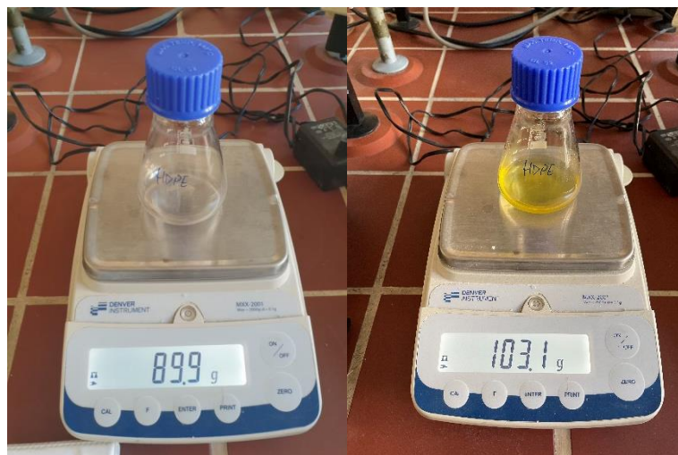
Slika 11. Čaša pred (prazna) in po postopku pirolize HDPE (s piroliznim oljem)
