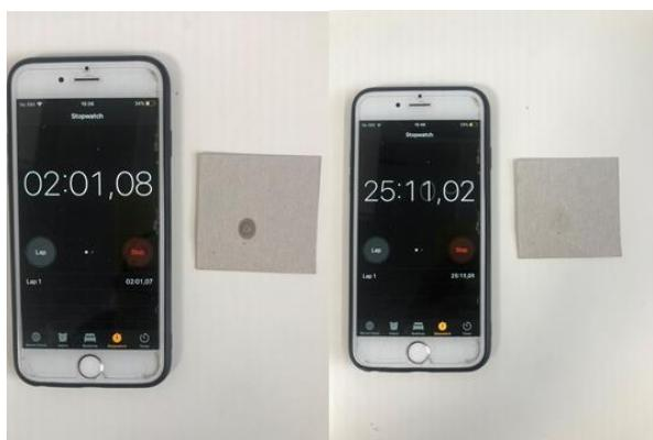
Slika 23: Testiranje vpojnosti in sušljivosti tanjšega kartona
