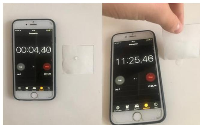
Slika 27: Testiranje vpojnosti in sušljivosti peki papirja
