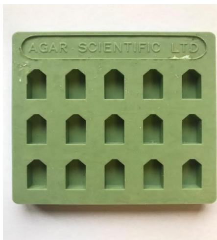
Slika 7: Plastični model za vklapljanje vzorcev v eponsko smolo
