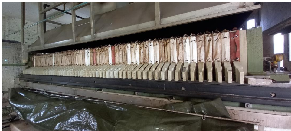
Slika 7: Stiskalnica aktivnega blata (Foto: Ivana, Ajda, Izak)
