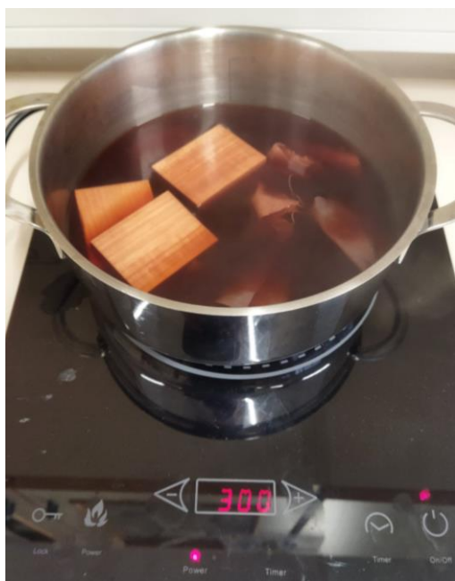
Slika 8: Barvanje vzorcev z barvilom iz octovca. (Foto: Vid Kodrič)
