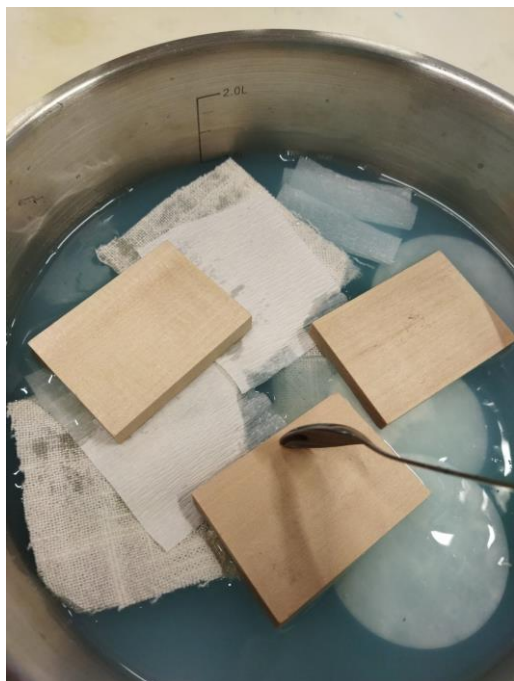
Slika 7: Čimžanje vzorcev iz S2. (Foto: Vid Kodrič)
