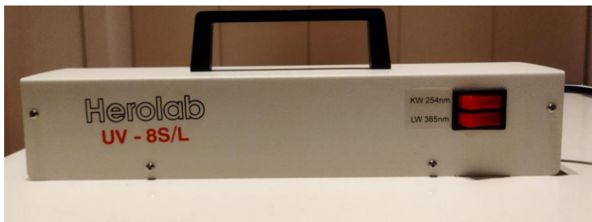
Slika 3: UV svetilka, uporabljena pri osvetljevanju vzorcev. (Foto: Vid Kodrič)
