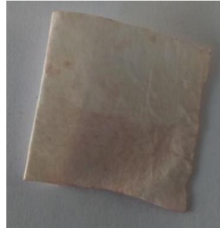
Slika 100: Polipropilen, barvana z barvilom lovorikovca, ekstrahiranim v vodni kopeli s sodo bikarbono.
