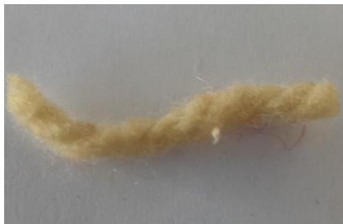
Slika 103: Volna, barvana z barvilom japonskega dresnika, ekstrahiranim v etanolu .
