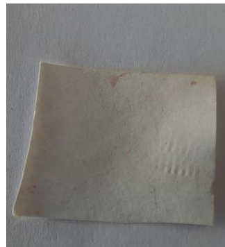
Slika 92: Papir, barvan z barvilom lovorikovca, ekstrahiranim v vodni kopeli s kisom.
