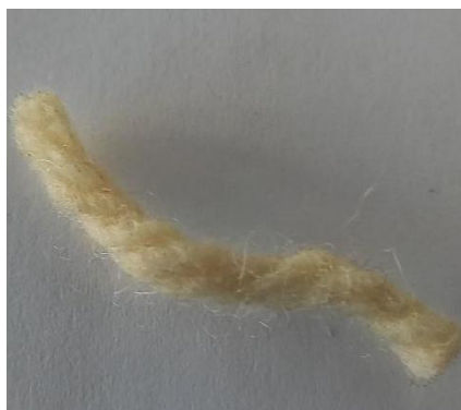
Slika 76: Volna, barvana z barvilom lovoricovca, ekstrahiranim v diklorometanu.
