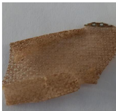
Slika 67: Polipropilen, barvan z barvilom octovca, ekstrahiranim v vodni kopeli s sodo bikarbono.
