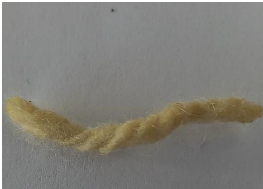
Slika 69: Volna, barvana z barvilom lovorikovca, ekstrahiranim v etanolu.
