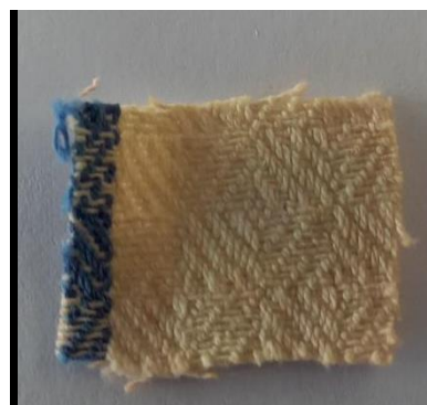
Slika 112: Bombažna krpa, barvana z barvilom japonskega dresnika, ekstrahiranim v diklorometanu.
