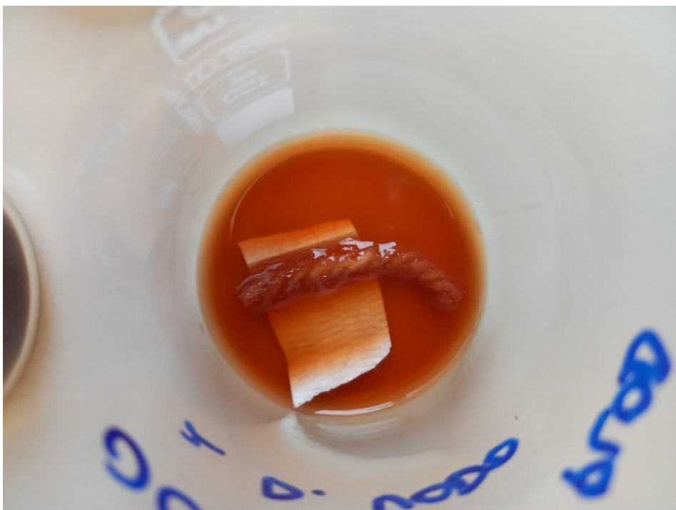
Slika 29: Barvanje volne in polipropilena v vodni kopeli z destilirano vodo.
