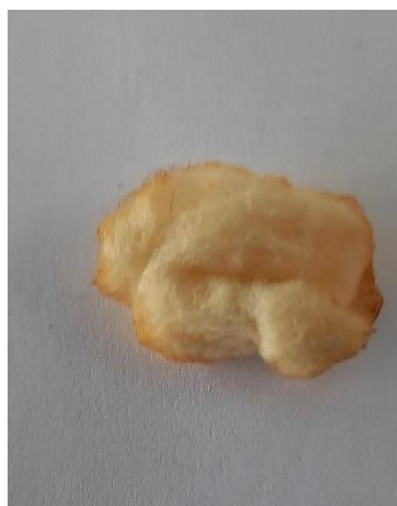
Slika 125: Bombažna vata, barvana z barvilom japonskega dresnika, ekstrahiranim v vodni kopeli s kisom.
