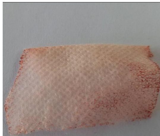
Slika 60: Polipropilen, barvan z barvilom octovca, ekstrahiranim v vodni kopeli s kisom.
