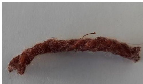
Slika 131: Volna, barvana z barvilom japonskega dresnika, ekstrahiranim v vodni kopeli s sodo bikarbono.
