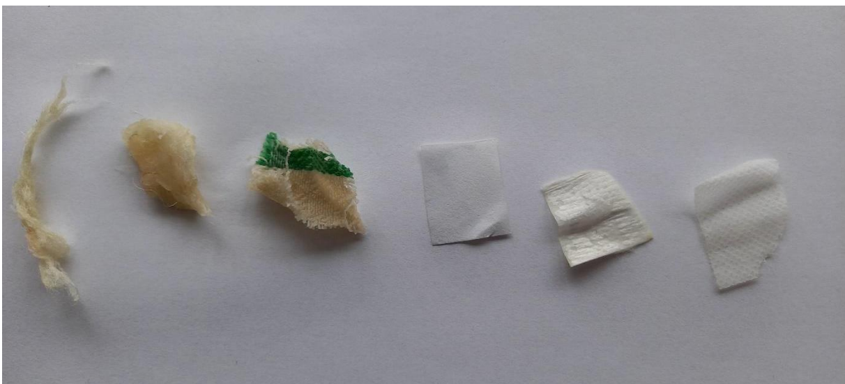
Slika 75: Volna, bombažna vata, bombažna krpa, papir in polipropilen, barvani z ekstraktom lovorikovca v etanolu po spiranju z vodo.
