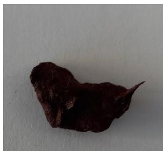
Slika 132: Bombažna vata, barvana z barvilom japonskega dresnika, ekstrahiranim v vodni kopeli s sodo bikarbono.
