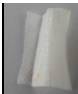
Slika 108: Polipropilen, barvan z barvilom japonskega dresnika, ekstrahiranim v etanolu .
