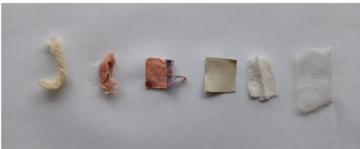
Slika 61: Volna, bombažna vata, bombažna krpa, papir in polipropilen, barvani z ekstraktom octovca v kopeli s kisom po spiranju z vodo.
