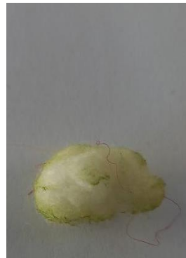
Slika 70: Bombažna vata, barvana z barvilom lovorikovca, ekstrahiranim v etanolu.
