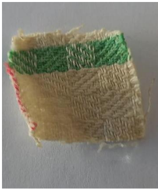
Slika 71: Bombažna krpa, barvana z barvilom lovorikovca, ekstrahiranim v etanolu.
