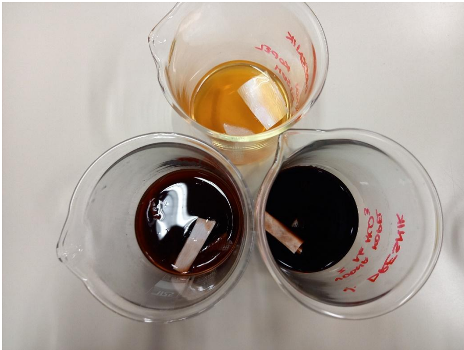
Slika 41: Barvanje umetnih mas in volne v kopeli z destilirano vodo, v kopeli s kisom in v kopeli z \text{NaHCO}_3 .
