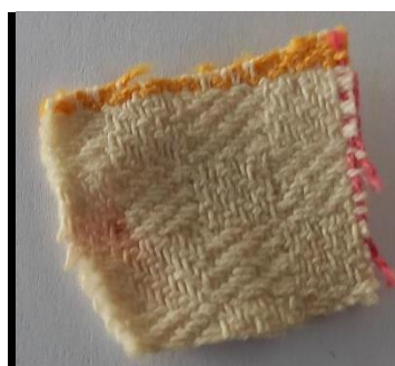
Slika 105: Bombažna krpa, barvana z barvilom japonskega dresnika, ekstrahiranim v etanolu .
