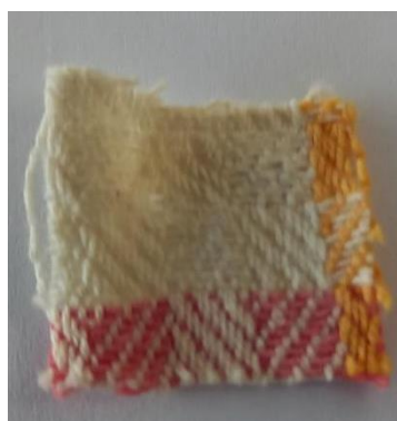
Slika 78: Bombažna krpa, barvana z barvilom lovoricovca, ekstrahiranim v diklorometanu.
