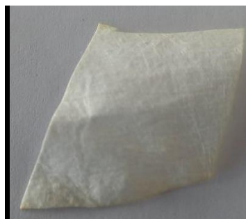
Slika 107: Polipropilen, barvan z barvilom japonskega dresnika, ekstrahiranim v etanolu .
