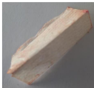
Slika 121: Polipropilen, barvan z barvilom japonskega dresnika, ekstrahiranim v vodni kopeli z destilirano vodo.
