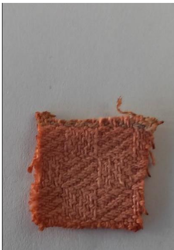
Slika 51: Bombažna krpa, barvana z barvilom octovca, ekstrahiranim v vodni kopeli z destilirano vodo.
