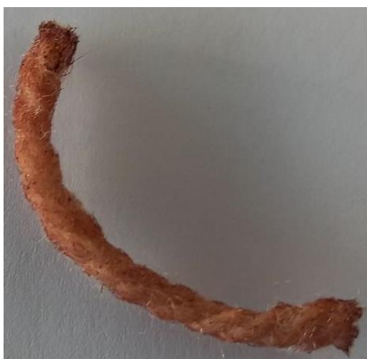
Slika 117: Volna, barvana z barvilom japonskega dresnika, ekstrahiranim v vodni kopeli z destilirano vodo.
