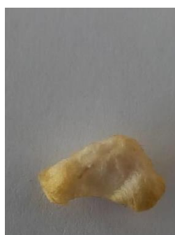
Slika 90: Bombažna vata, barvana z barvilom lovorikovca, ekstrahiranim v vodni kopeli s kisom.
