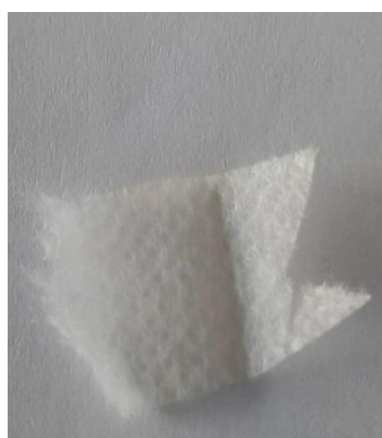
Slika 81: Polipropilen, barvana z barvilom lovoricovca, ekstrahiranim v diklorometanu.
