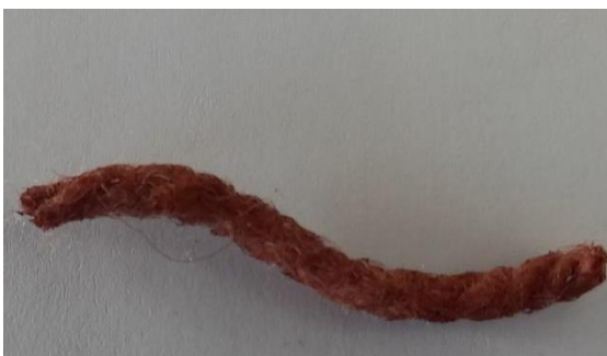
Slika 96: Volna, barvana z barvilom lovorikovca, ekstrahiranim v vodni kopeli s sodo bikarbono.
