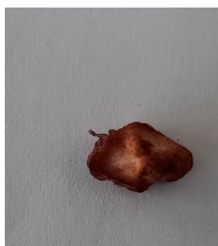
Slika 83: Bombažna vata, barvana z barvilom lovorikovca, ekstrahiranim v vodni kopeli z destilirano vodo.
