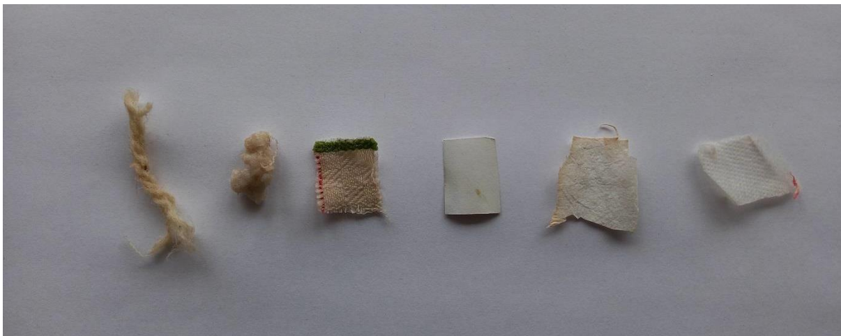
Slika 48: Volna, bombažna vata, bombažna krpa, papir in polipropilen, barvani z ekstraktom octovca v etanolu, po spiranju z vodo.
