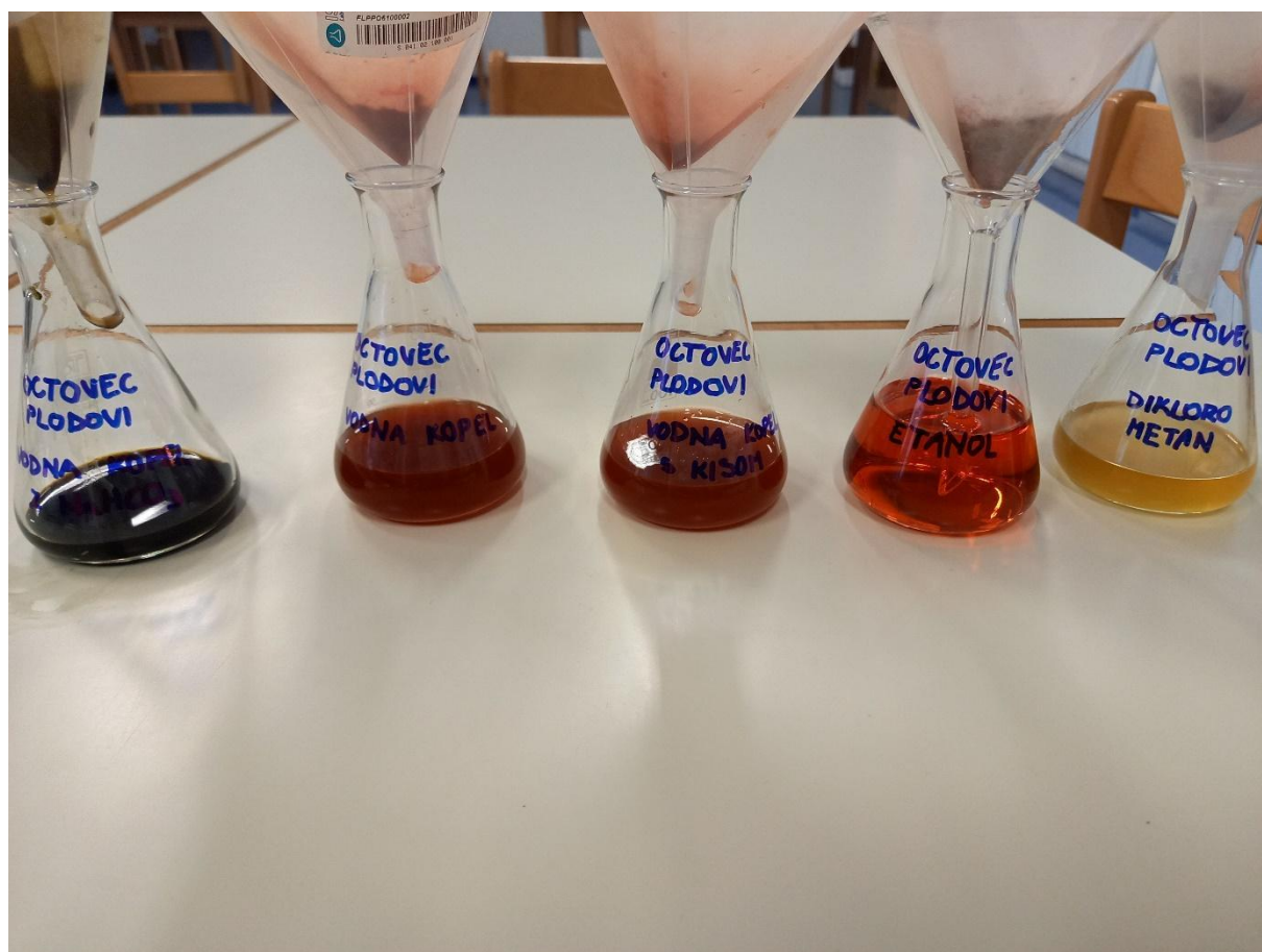
Slika 27: Ekstrakti barvil iz plodov octovca v različnih topilih.
