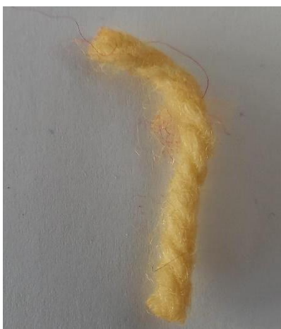
Slika 124: Volna, barvana z barvilom japonskega dresnika, ekstrahiranim v vodni kopeli s kisom.
