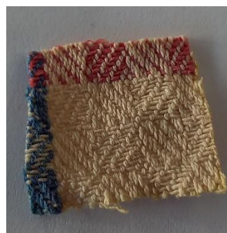
Slika 91: Bombažna krpa, barvana z barvilom lovorikovca, ekstrahiranim v vodni kopeli s kisom.
