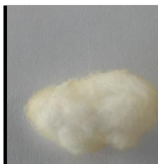
Slika 104: Bombažna vata, barvana z barvilom japonskega dresnika, ekstrahiranim v etanolu .
