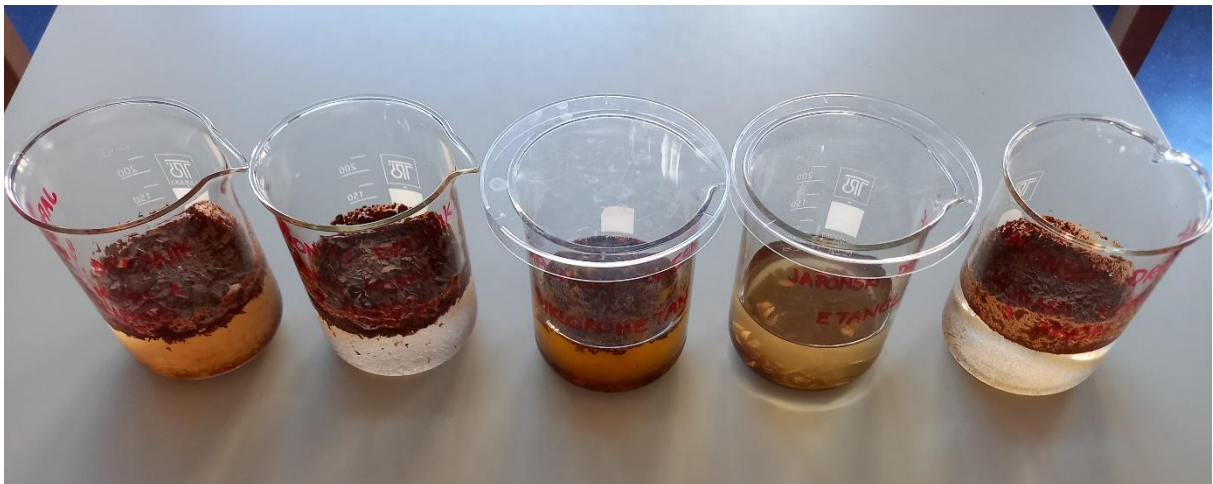
Slika 39: Ekstrahiranje barvil iz zmletih listov japonskega dresnika.
