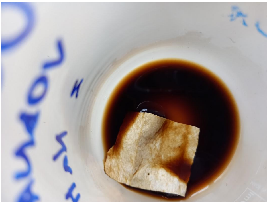
Slika 30: Barvanje volne in polipropilena v vodni kopeli z \text{NaHCO}_3 (soda bikarbona).
