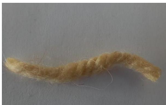
Slika 89: Volna, barvana z barvilom lovorikovca, ekstrahiranim v vodni kopeli s kisom.
