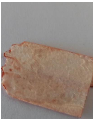
Slika 59: Polipropilen, barvan z barvilom octovca, ekstrahiranim v vodni kopeli s kisom.
