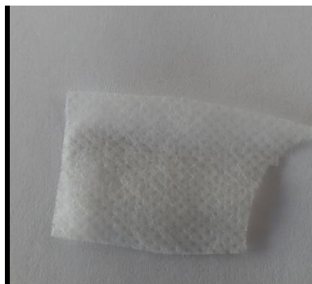
Slika 115: Polipropilen, barvan z barvilom japonskega dresnika, ekstrahiranim v diklorometanu.
