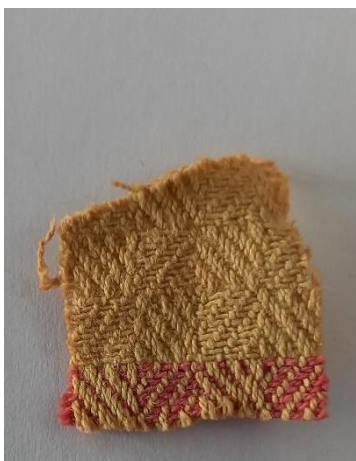
Slika 126: Bombažna krpa, barvana z barvilom japonskega dresnika, ekstrahiranim v vodni kopeli s kisom.
