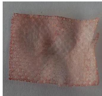
Slika 101: Polipropilen, barvana z barvilom lovorikovca, ekstrahiranim v vodni kopeli s sodo bikarbono.
