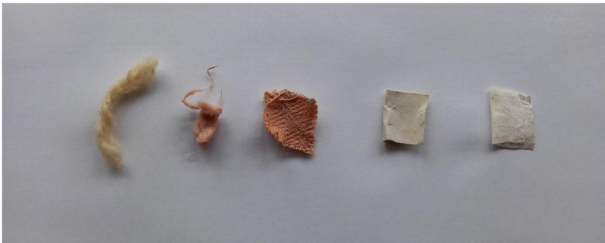
Slika 54: Volna, bombažna vata, bombažna krpa, papir in polipropilen, barvani z ekstraktom octovca v kopeli z destilirano vodo, po spiranju z vodo.
