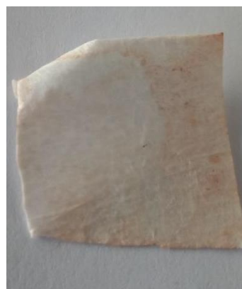
Slika 86: Polipropilen, barvana z barvilom lovorikovca, ekstrahiranim v vodni kopeli z destilirano vodo.
