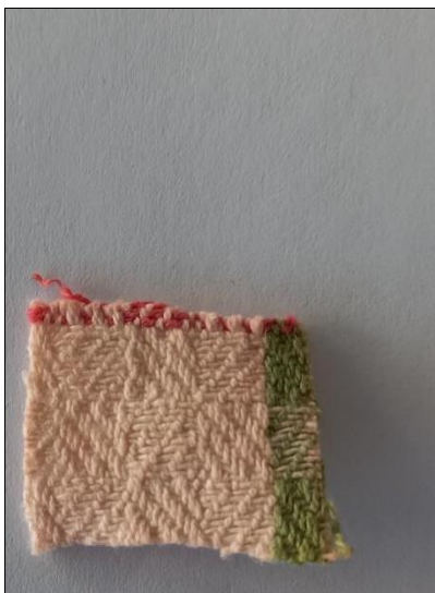
Slika 44: Bombažna krpa, barvana z barvilom octovca, ekstrahiranim v etanolu.
