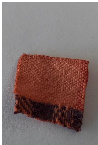
Slika 57: Bombažna krpa, barvana z barvilom octovca, ekstrahiranim v vodni kopeli s kisom.
