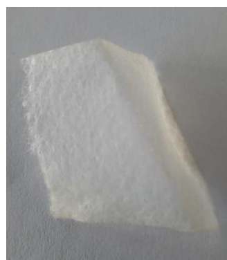
Slika 129: Polipropilen, barvan z barvilom japonskega dresnika, ekstrahiranim v vodni kopeli s kisom.
