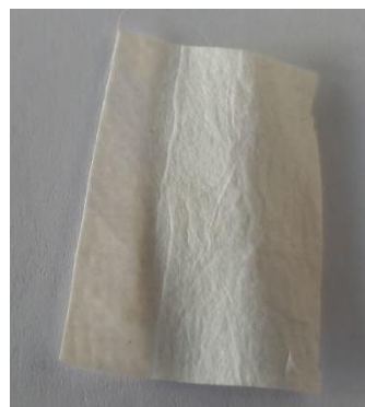
Slika 128: Polipropilen, barvan z barvilom japonskega dresnika, ekstrahiranim v vodni kopeli s kisom.
