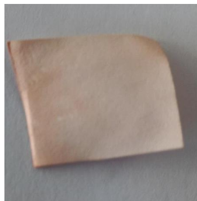
Slika 85: Papir, barvan z barvilom lovorikovca, ekstrahiranim v vodni kopeli z destilirano vodo.
