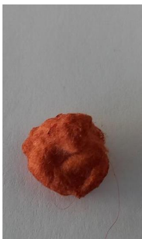
Slika 56: Bombažna vata, barvana z barvilom octovca, ekstrahiranim v vodni kopeli s kisom.
