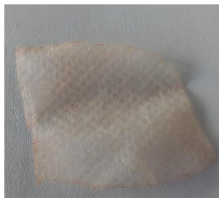
Slika 87: Polipropilen, barvana z barvilom lovorikovca, ekstrahiranim v vodni kopeli z destilirano vodo.
