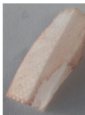
Slika 122: Polipropilen, barvan z barvilom japonskega dresnika, ekstrahiranim v vodni kopeli z destilirano vodo.
