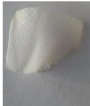
Slika 74: Polipropilen, barvan z barvilom lovorikovca, ekstrahiranim v etanolu.
