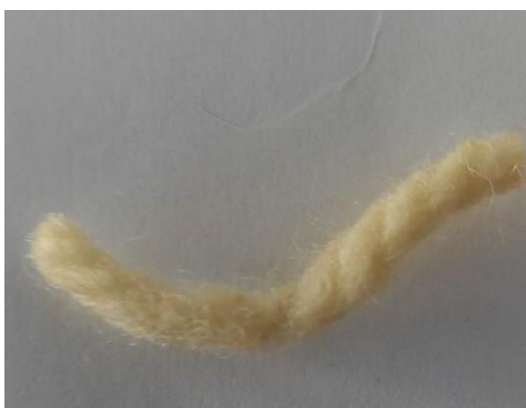
Slika 110: Volna, barvana z barvilom japonskega dresnika, ekstrahiranim v diklorometanu.
