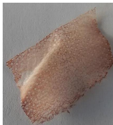
Slika 136: Polipropilen, barvan z barvilom japonskega dresnika, ekstrahiranim v vodni kopeli s sodo bikarbono.
