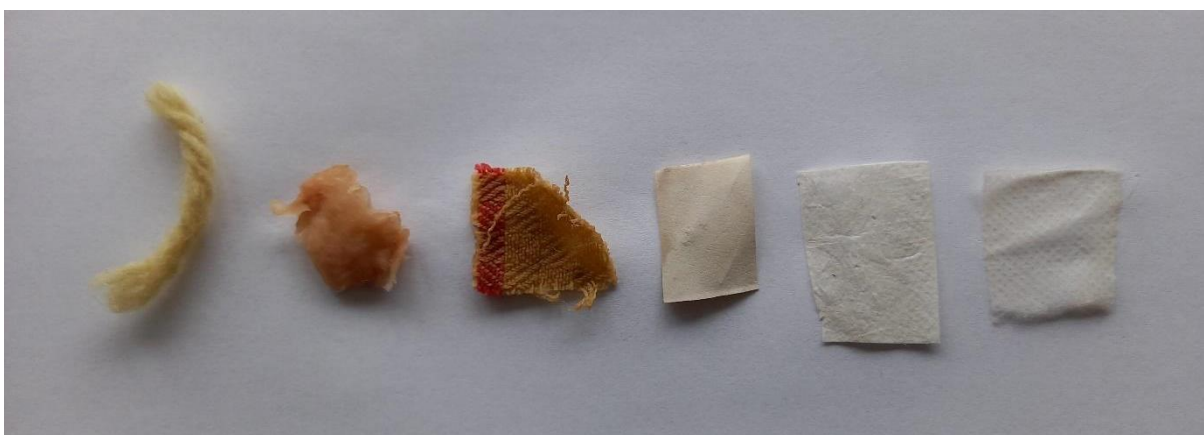
Slika 130: Volna, bombažna vata, bombažna krpa, papir in polipropilen, barvani z ekstraktom japonskega dresnika v vodni kopeli s kisom po spiranju z vodo.
