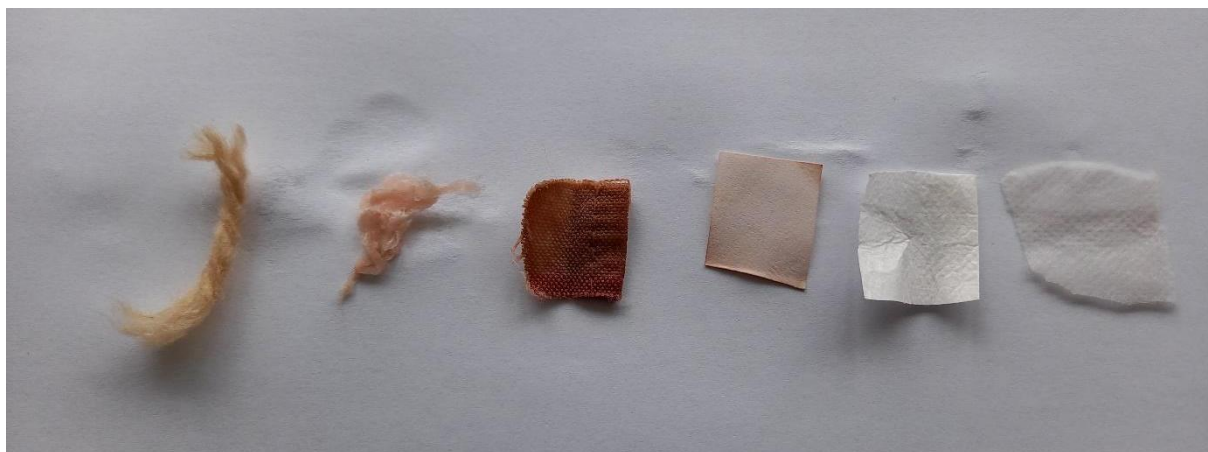
Slika 88: Volna, bombažna vata, bombažna krpa, papir in polipropilen, barvani z ekstraktom lovorikovca v vodni kopeli z destilirano vodo po spiranju z vodo.
