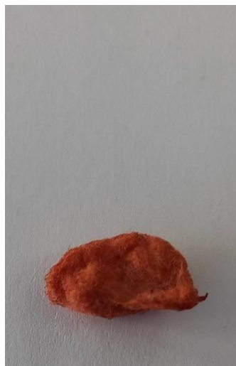
Slika 50: Bombažna vata, barvana z barvilom octovca, ekstrahiranim v vodni kopeli z destilirano vodo.
