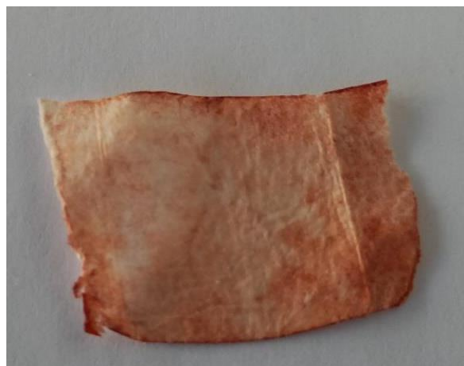
Slika 53: Polipropilen, barvan z barvilom octovca, ekstrahiranim v vodni kopeli z destilirano vodo.
