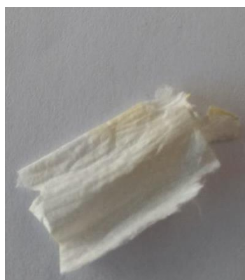
Slika 80: Polipropilen, barvana z barvilom lovoricovca, ekstrahiranim v diklorometanu.
