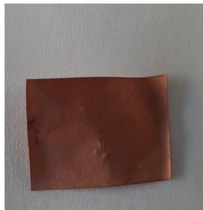
Slika 134: Papir, barvan z barvilom japonskega dresnika, ekstrahiranim v vodni kopeli s sodo bikarbono.
