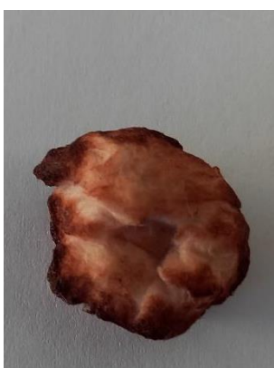
Slika 118: Bombažna vata, barvana z barvilom japonskega dresnika, ekstrahiranim v vodni kopeli z destilirano vodo.
