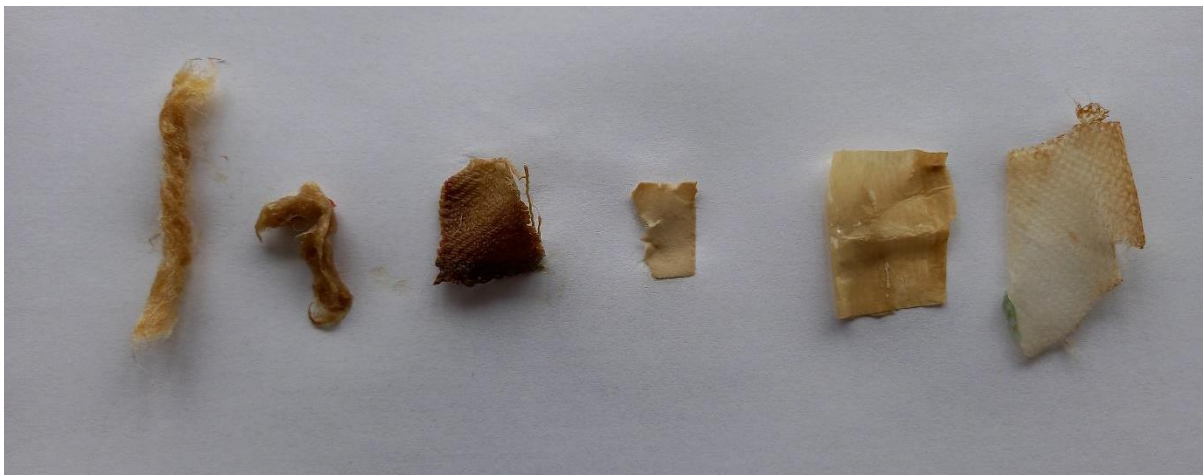
Slika 68: Volna, bombažna vata, bombažna krpa, papir in polipropilen, barvani z ekstraktom octovca v kopeli s sodo bikarbono po spiranju z vodo.
