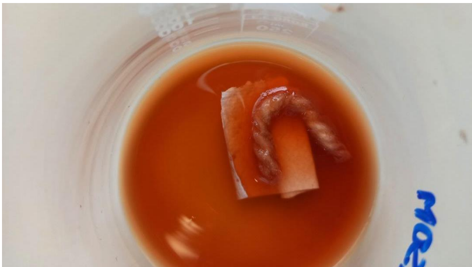
Slika 28: Barvanje volne in polipropilena v vodni kopeli s kisom.
