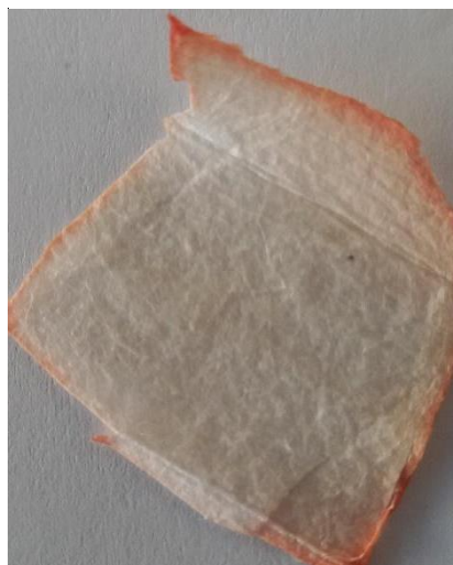
Slika 46: Polipropilen, barvan z barvilom octovca, ekstrahiranim v etanolu.
