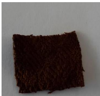
Slika 64: Bombažna krpa, barvana z barvilom octovca, ekstrahiranim v vodni kopeli s sodo bikarbono.
