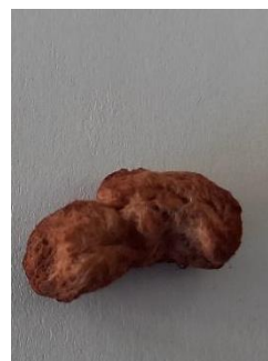
Slika 97: Bombažna vata, barvana z barvilom lovorikovca, ekstrahiranim v vodni kopeli s sodo bikarbono.
