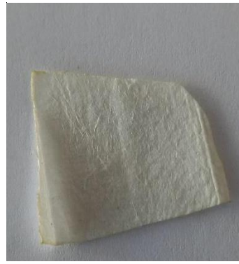
Slika 73: Polipropilen, barvan z barvilom lovorikovca, ekstrahiranim v etanolu.
