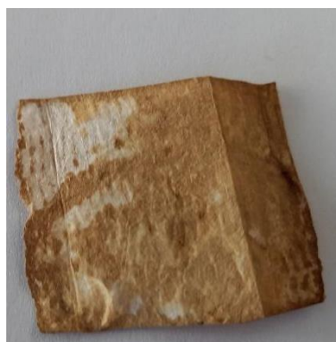
Slika 66: Polipropilen, barvan z barvilom octovca, ekstrahiranim v vodni kopeli s sodo bikarbono.
