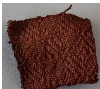
Slika 133: Bombažna krpa, barvana z barvilom japonskega dresnika, ekstrahiranim v vodni kopeli s sodo bikarbono.
