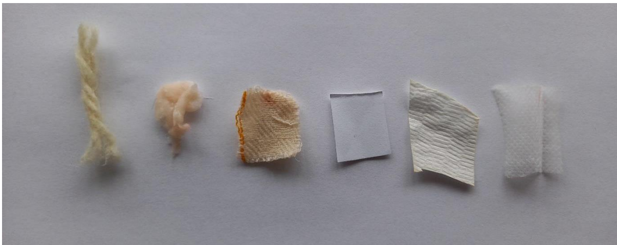
Slika 109: Volna, bombažna vata, bombažna krpa, papir in polipropilen, barvani z ekstraktom japonskega dresnika v etanolu po spiranju z vodo.
