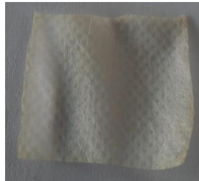
Slika 94: Polipropilen, barvan z barvilom lovorikovca, ekstrahiranim v vodni kopeli s kisom.
