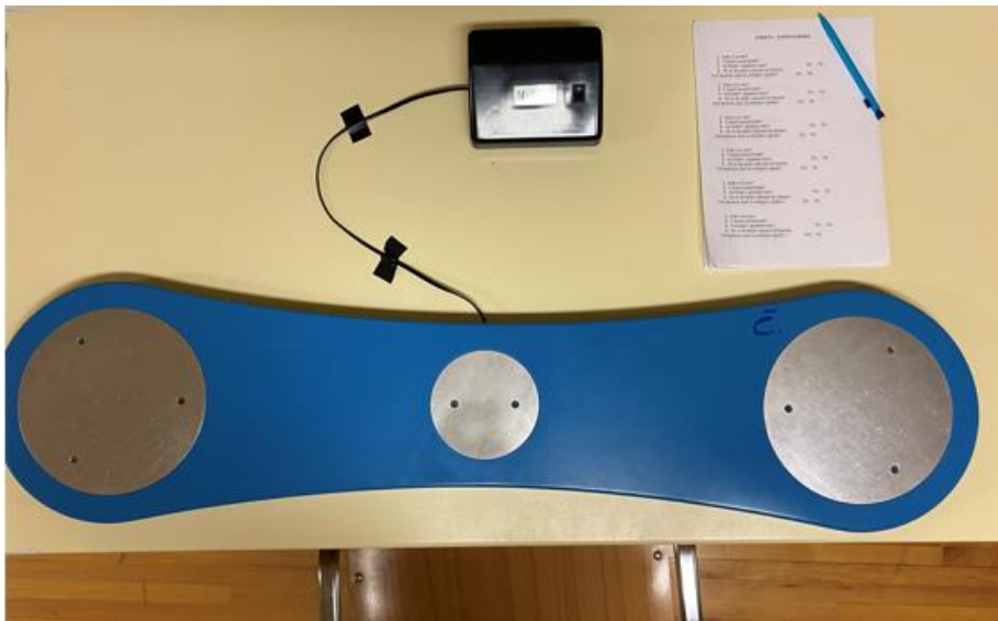
Slika 1. Deska za elektronsko merjenje števila dotikov.
