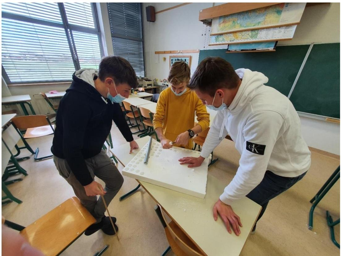
Slika 6: Priprava čepa iz stiropora, debeline 5 cm, in vrtanje luknje, premera 1 cm, v čep.
