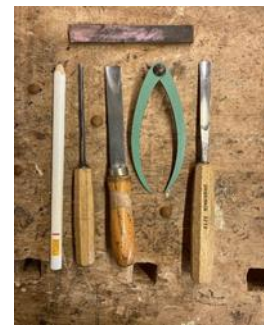
Slika 110, slika 111, slika 112, slika 113: Rezbarsko orodje, ki ga uporabljajo v Srednji lesarski šoli Maribor. Rezbarski nožički in dleta (1), rezbarski nožki (2), posebna rezbarska dleta (3), svinčnik, dleta (široko, ozko, šilasto), rezbarsko šestilo in brusni kamen (4) (vir: lastne fotografije, 2022).
