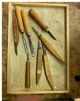
Slika 110, slika 111, slika 112, slika 113: Rezbarsko orodje, ki ga uporabljajo v Srednji lesarski šoli Maribor. Rezbarski nožički in dleta (1), rezbarski nožki (2), posebna rezbarska dleta (3), svinčnik, dleta (široko, ozko, šilasto), rezbarsko šestilo in brusni kamen (4) (vir: lastne fotografije, 2022).
