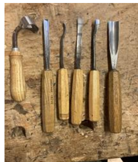
Slika 110, slika 111, slika 112, slika 113: Rezbarsko orodje, ki ga uporabljajo v Srednji lesarski šoli Maribor. Rezbarski nožički in dleta (1), rezbarski nožki (2), posebna rezbarska dleta (3), svinčnik, dleta (široko, ozko, šilasto), rezbarsko šestilo in brusni kamen (4) (vir: lastne fotografije, 2022).
