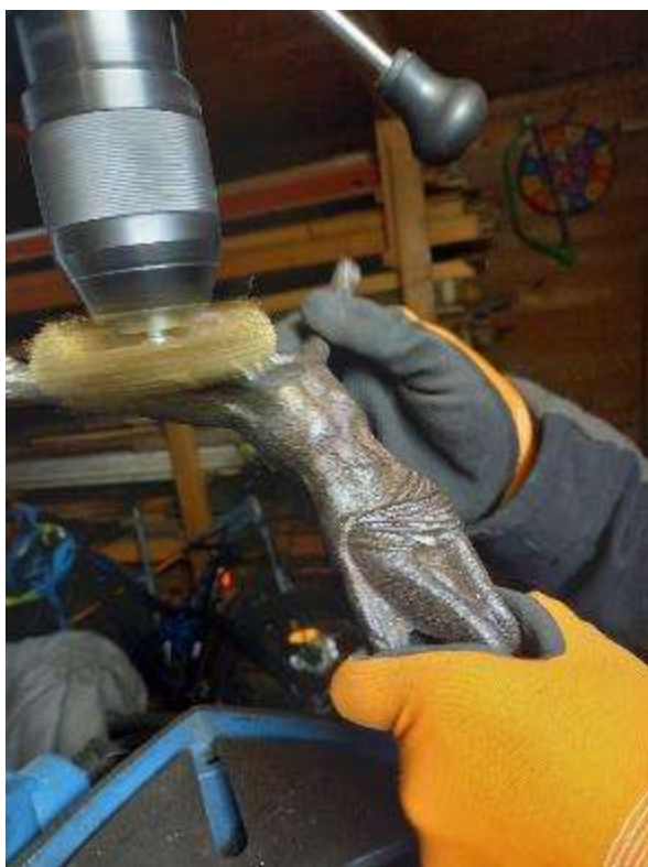
Slika 38 in Slika 39: Čiščenje in zaščita (lakiranje) ulitka
