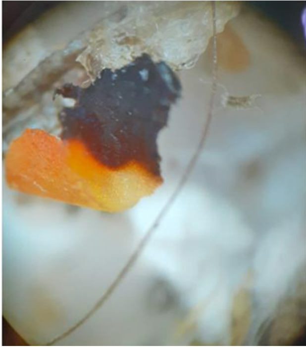
Slika 24: Delci mikroplastike pri tretji meritvi na lokaciji Premogovnika Velenje – levo slika skozi lupo stereo mikroskopa, desno slika materiala v petrijevki (Foto: D. Lamot)
