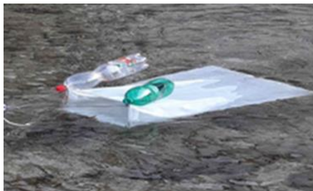
Slika 6: Mreža za vzorčenje mikroplastike v Paki (Foto: D. Lamot)
