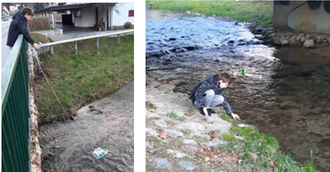
Slika 7: Nastavljanje mreže za vzorčenje mikroplastike v vodo (levo) in zajemanje vzorca vode v čašo (desno) (Foto: R. Blagus)
