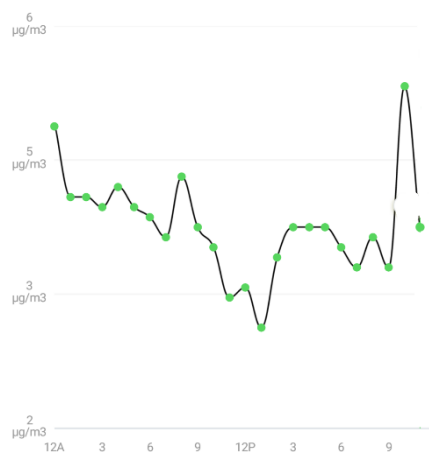
Slika 36: Koncentracije prašnih delcev manjših od 2,5 µm, pri tiskanju testnega modela z visokozmogljivim polistirenom (HIPS)
