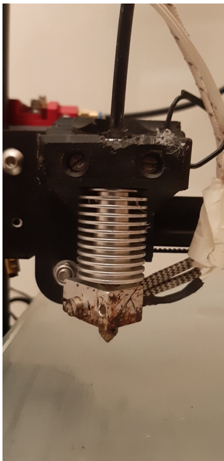
Slika 13: Nadomestna glava tiskalnika, ki je narejena v celoti iz kovine in omogoča tiskanje na višjih temperaturah
