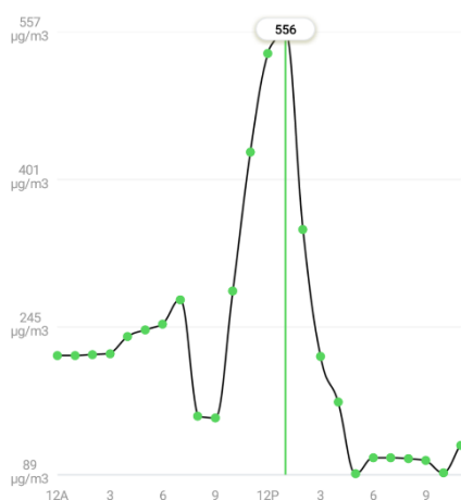
Slika 25: Izpusti lahkihlahlapnih ogljikovodikov pri tiskanju testnega modela z materialom polivinil alkohol (PVA)
