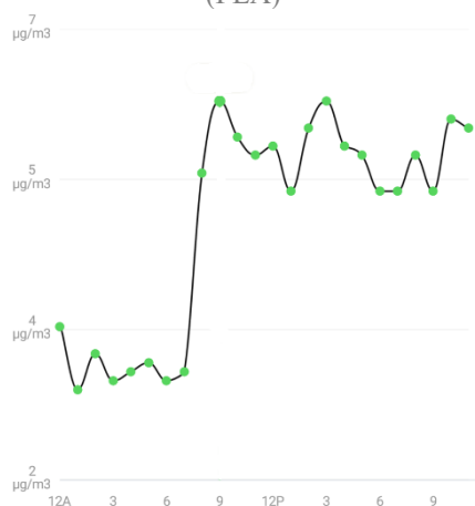
Slika 31: Koncentracije prašnih delcev manjših od 2,5 µm, pri tiskanju testnega modela s poliaktično kislino (PLA) z dodatkom lesa
