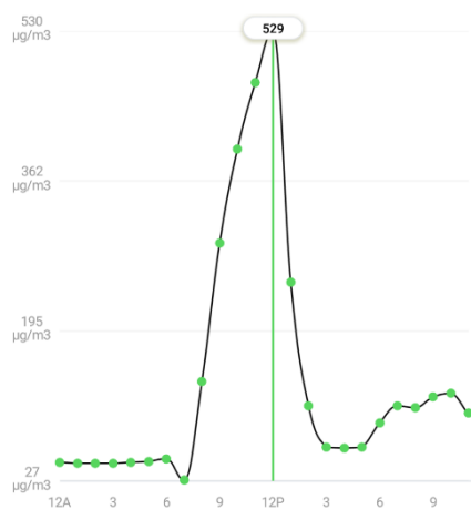
Slika 28: Izpusti lahkihlahlapnih ogljikovodikov pri tiskanju testnega modela s fleksibilnim materialom, sestavljenim iz poliuretana in dodatkov
