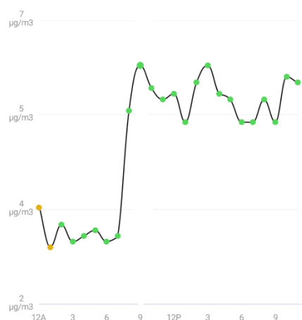
Slika 37: Koncentracije prašnih delcev manjših od 2,5 µm, pri tiskanju testnega modela z materialom akrilonitril butadien stiren (ABS)
