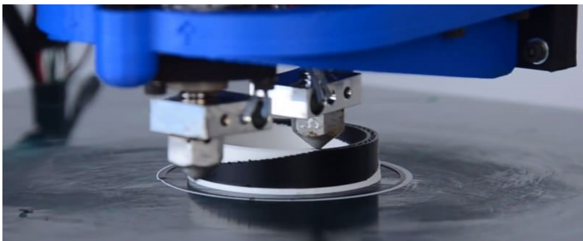
Slika 7: Fotografija tiskalnika z dvema vzporednima glavama ( https://tobuya3dprinter.com/dual-extruders-worth/ )
