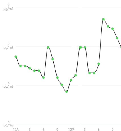
Slika 33: Koncentracije prašnih delcev manjših od 2,5 µm, pri tiskanju testnega modela z materialom akrilonitril stiren akrilat (ASA)
