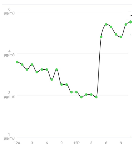
Slika 30: Koncentracije prašnih delcev manjših od 2,5 µm, pri tiskanju testnega modela s poliaktično kislino (PLA)
