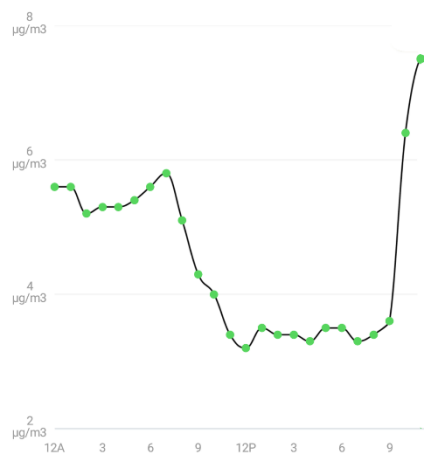
Slika 32: Koncentracije prašnih delcev manjših od 2,5 µm, pri tiskanju testnega modela z materialom polietilen tereftalat glikol (PETG)
