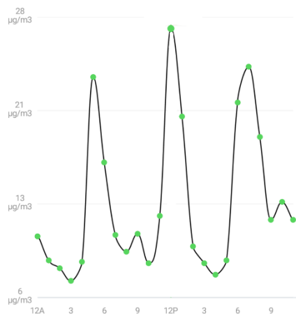
Slika 38: Koncentracije prašnih delcev manjših od 2,5 µm, pri tiskanju testnega modela s fleksibilnim materialom, sestavljenim iz poliuretana in dodatkov
