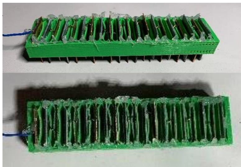
**Slika 13:** 3D natisnjen okvir z desetimi pari zaporedno vezanih ploščatih elektrod (Cu-Zn). Vidni so ostanki lepila, ki so služili za boljšo fiksacijo ploščic (foto: Gabrijel Petkovšek)
