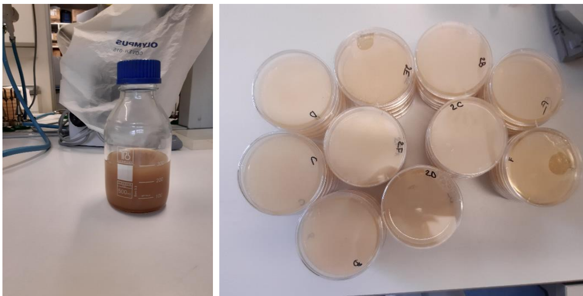
Slika 3: Pripravljeno gojišče PDA, združeno s preiskovanimi raztopinami (levo), prelito v petrijevke, pripravljene za nanos plesni – inokulacijo (foto: Zala Kralj)
